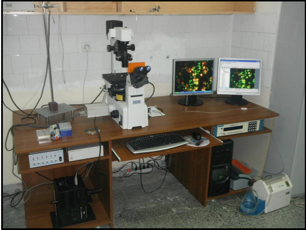
Şekil 2: Floresan kalsiyum görüntüleme sisteminin fotoğrafik görünümü. İlaç uygulama/mikroinkübasyon sistemi (sol üst kısım), CCD kamera (sol alt), ters mikroskop ve filtre sürücüsü kontrol ünitesi (sağ).
