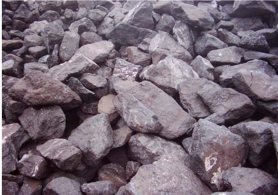
Şekil 6.5. Kapin bölgesine ait refrakter nitelikli krom cevherleri.
