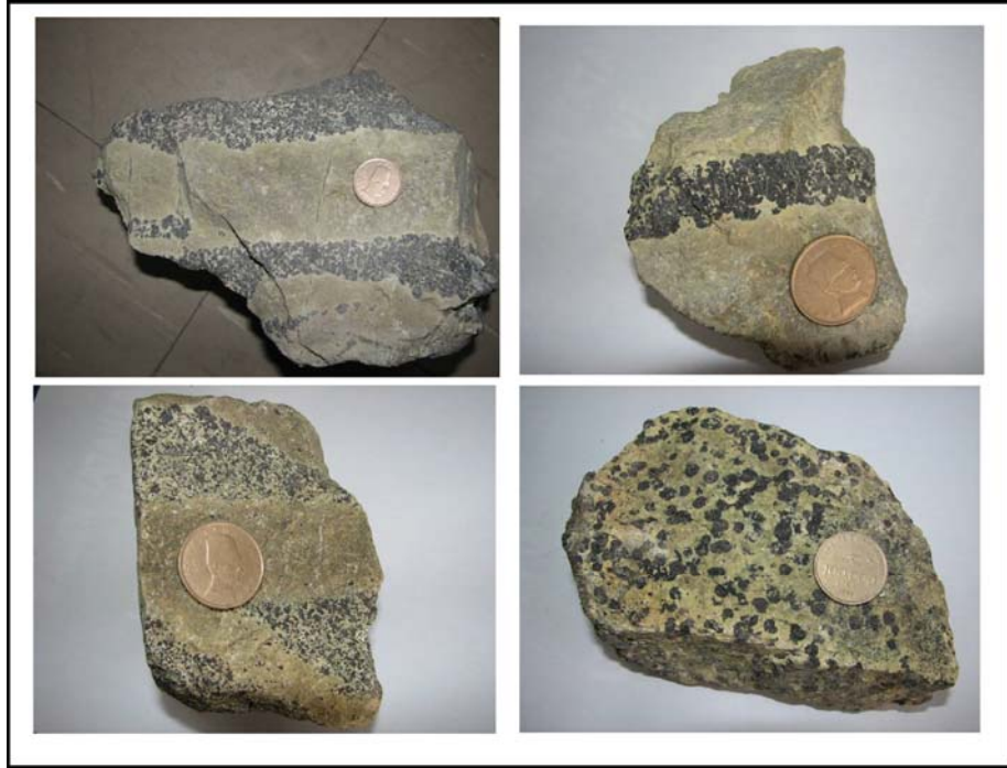
Şekil 6.12. Guleman Bölgesinde görülen saçınımlı-bantlı, kama ve nodüler cevher.
