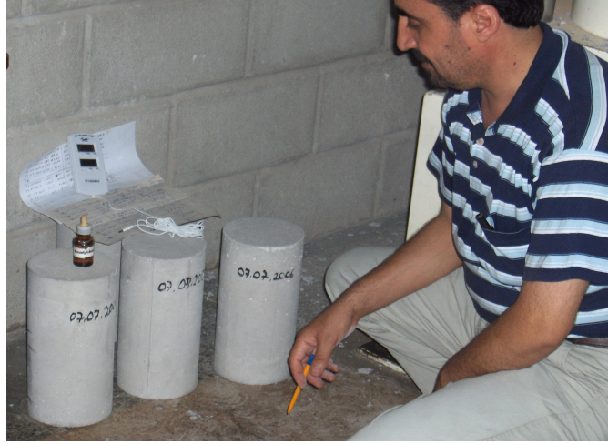
Şekil 6.6. Numunelerin bulunduğu ortamdaki sıcaklık ve bağıl nemin takibi
