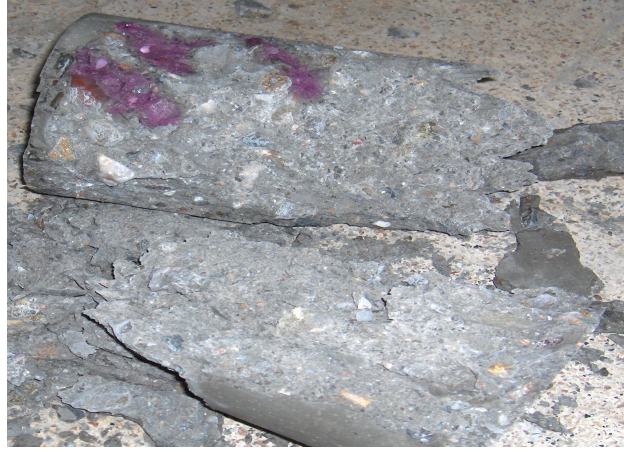
Şekil 6.9. Karbonatlaşma meydana gelmemiş numuneler
