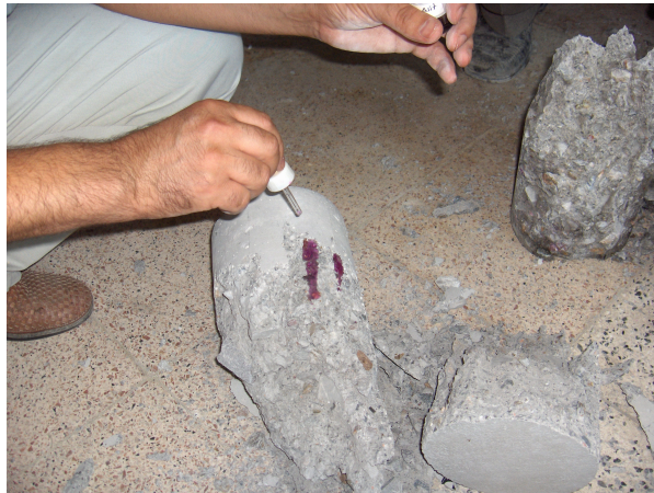
Şekil 6.8. %92 bağıl neme maruz kalmış numunelerde karbonatlaşma testi
