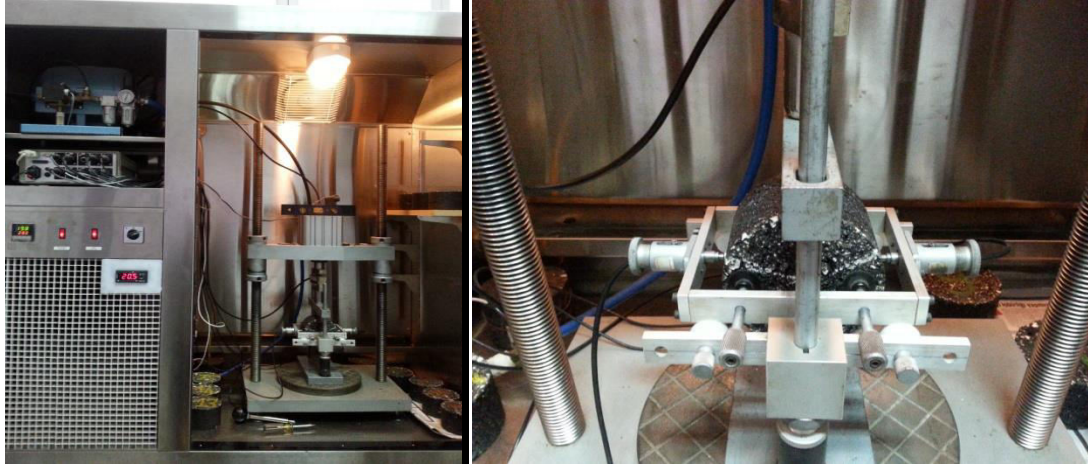
Şekil 4.26. UTM cihazı ve ITSM deney düzeneği
