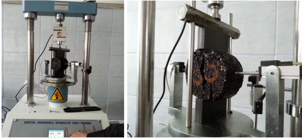
Şekil 4.25. Çekme dayanımı deney düzeneği
