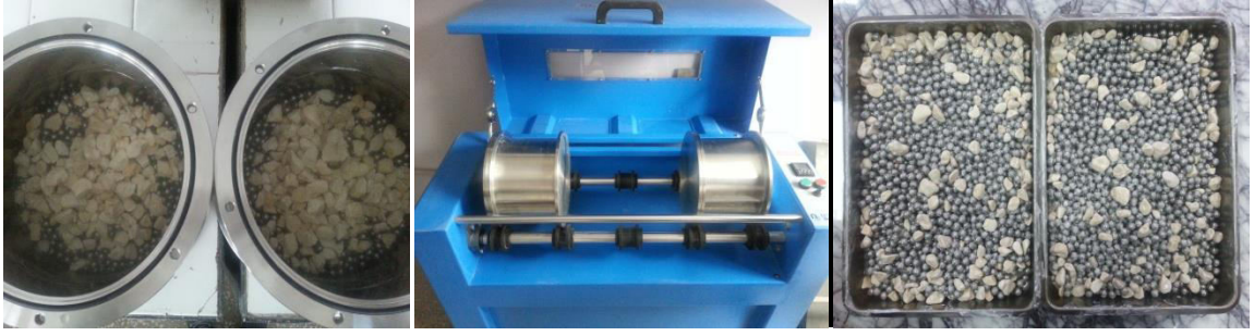
Şekil 4.20. Mikro-Deval deney aleti ve deney numuneleri
