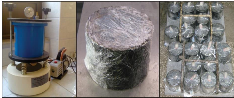
Şekil 4.24. Piknometre ve vakum cihazı, numunelerin koşullandırma işlemi için hazırlanması
