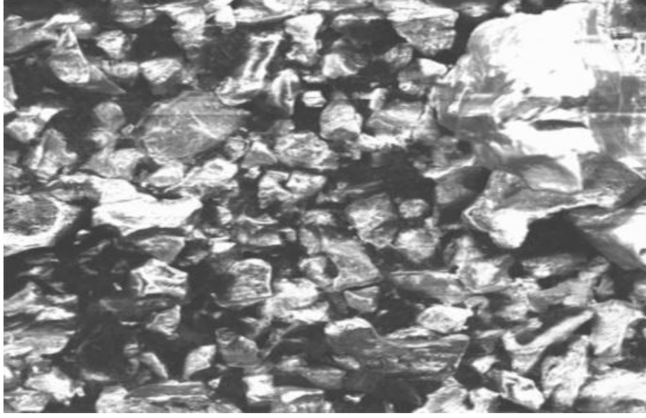
Şekil 6.5. 800°C’de B 4 C Numunesinin x1000 Büyütmedeki SEM Görüntüsü
