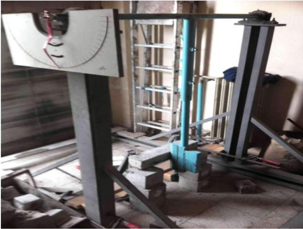
Şekil 3.7. Charpy deney düzeneği ve numunenin yerleştirilmesi
