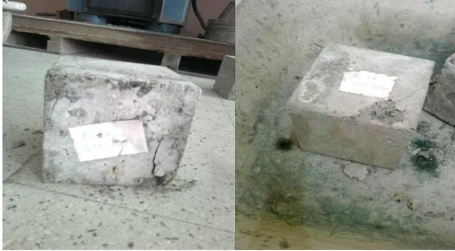
Şekil 3.4. Basınç dayanımı deneyi sonucunda numunenin kırılma şekli
