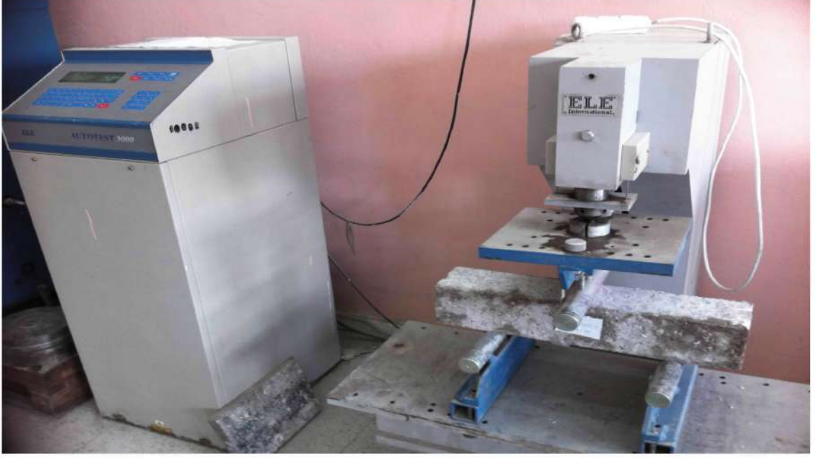
Şekil 3.5. Eğilme yükü altında kırılma deney düzeneği ve deney numunesi
