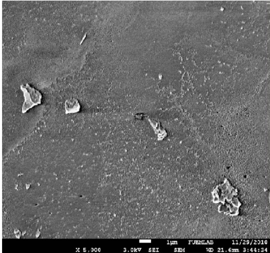
Şekil 4.1. Molibden çözeltisiyle (1000 ppm) işlem görmüş kuvars tüpün SEM görüntüsü (x5000)
