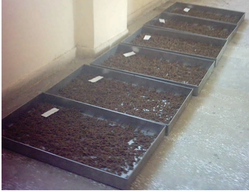
Şekil 3.4 Hazırlanan peletlerin pişirme tepsilerine yerleştirilmesi.
