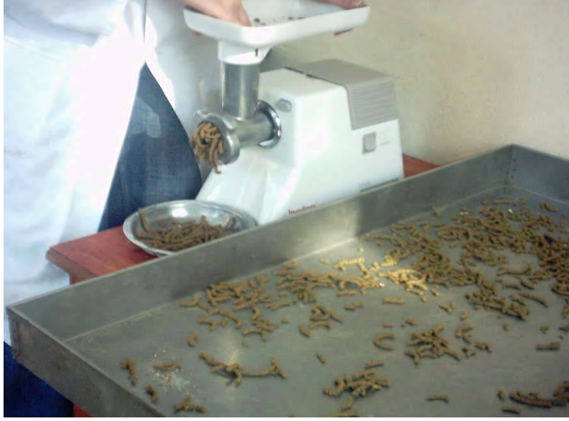
Şekil 3.2. Hamur haldeki yem materyalinin kıyma makinesinden geçirilerek pelet haline getirilmesi.
