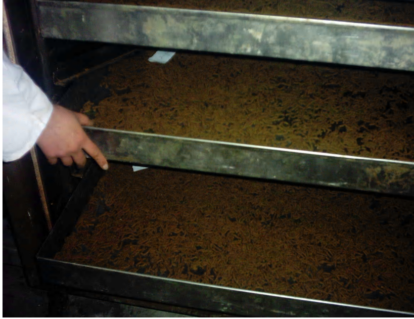
Şekil 3.5. Peletlenen yemlerin yem fırınında pişirilmesi.
