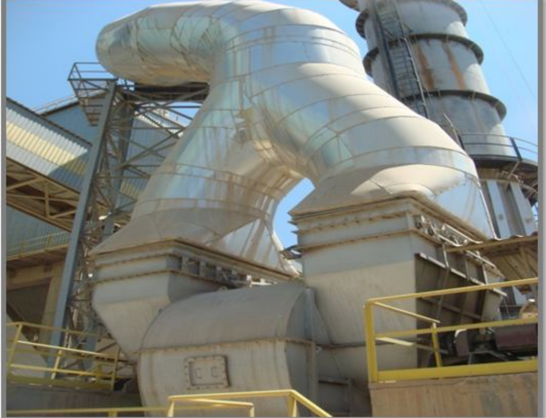
Foto 14: Döner Fırın Siklonları (1.Siklon) (Siklon=Ön Isıtıcı)
