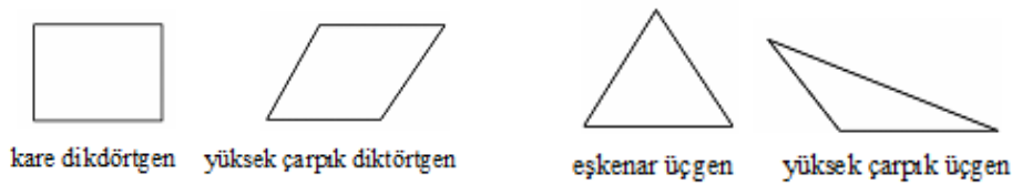
Şekil 4.3. İki boyutlu yüzeysel ağ oluşturan elemanların standart ve çarpık halleri
