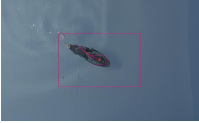
Şekil 6.3. Kinovea 0.8.26 programı ile robot balık prototipinde işaretli bölgenin takip edilmesi
