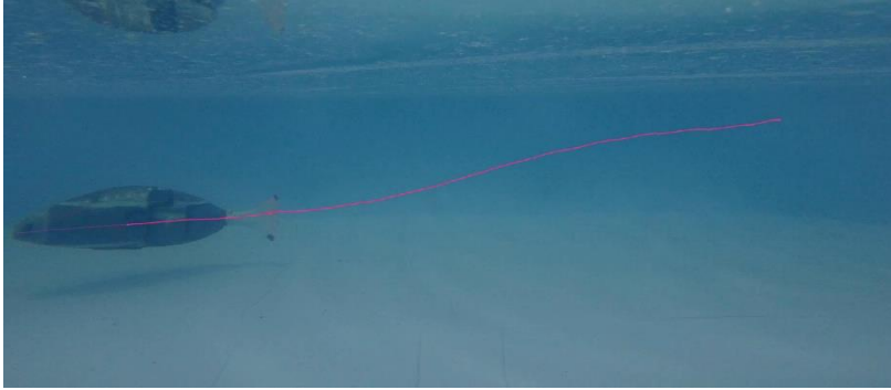
Şekil 6.68. Basamak yunuslama açısı referansı için robot balığın kapalı çevrim deneysel görüntüleri
