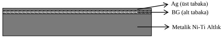
Şekil 2.8. BG-Ag kaplama yapılmış Ni-Ti metalik altlıkta, kaplama tabakalarının şematik gösterimi.
