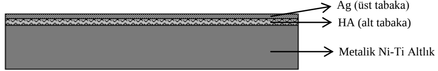
Şekil 2.6. HA-Ag kaplama yapılmış Ni-Ti metalik altlıkta, kaplama tabakalarının şematik gösterimi.
