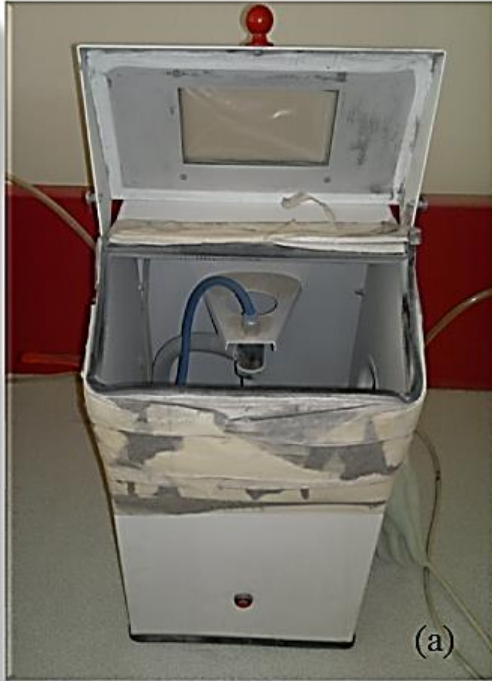
Şekil 2.2 (a) Kumlama Kabini ve (b) Ultrasonic Cleaner
