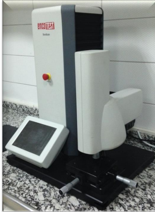
Şekil 2.12. Sertlik ölçüm cihazı EMCO TEST DURASCAN 0,098 – 98 N / 0,01 – 10 kgf)
