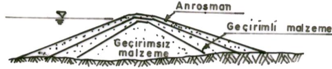
Şekil 2.14. Toprak dolgu gövde tipi
