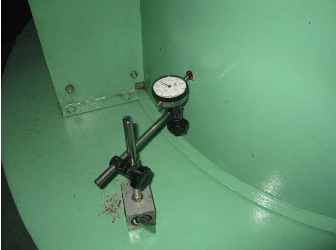
řekil 2.11. Trbin kılavuz yatak st kısmında řafttan llen salınım miktarı
