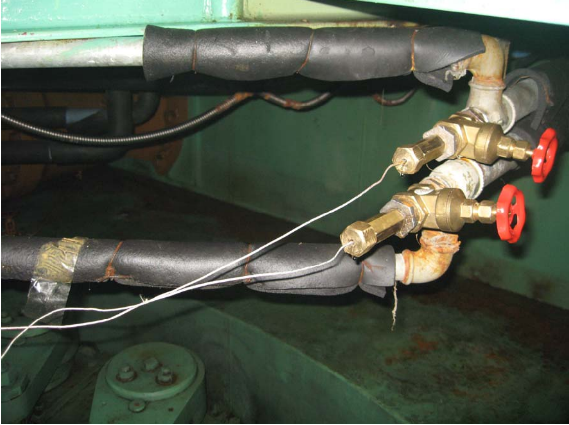
Şekil 2.14. Plakalı eşanjör soğutma suyu giriş ve çıkışına bağlanan ısıl çiftler
