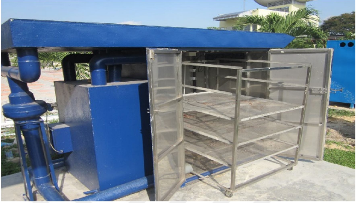
Şekil 2.13. Güneş enerjisi destekli ısı pompalı kurutucu
