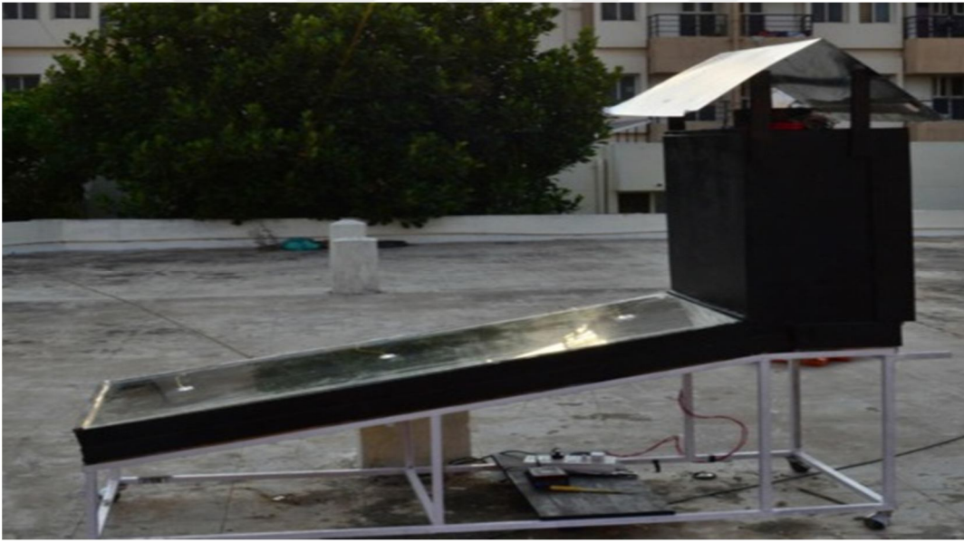
Şekil 2.4. Güneş enerjili kurutma sistemi
