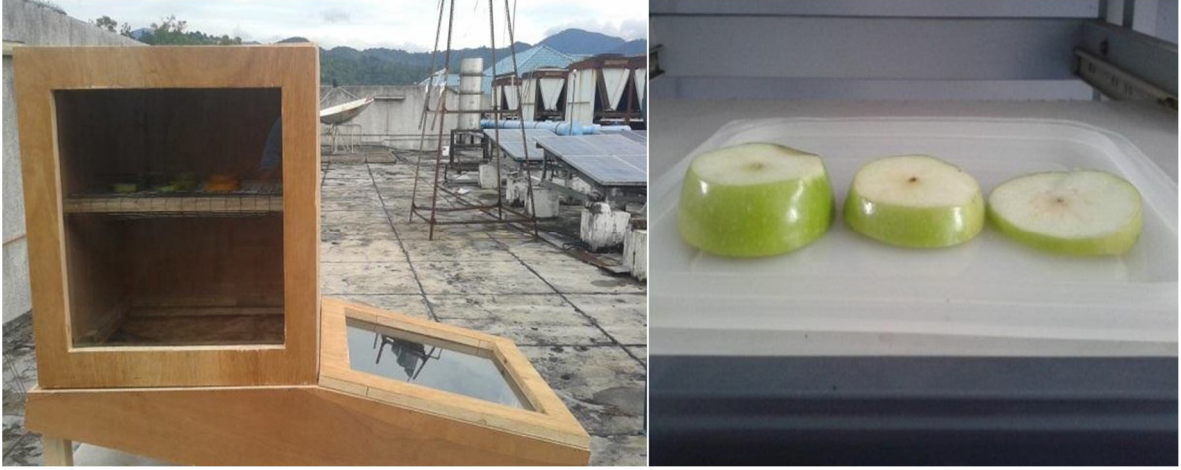
Şekil 2.11. Doğal ve zorlanmış akışlı güneş enerjili kurutma sistemi ve kurutulacak ürünler
