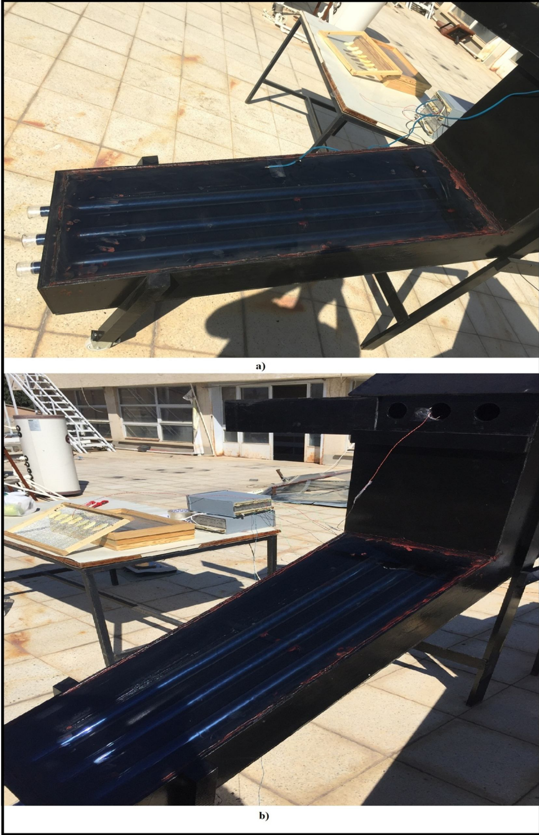
Şekil 4.6. İmalatı tamamlanan borulu kolektöre sahip kurutucunun a) kolektör bölümü ve b) genel görünüşü
