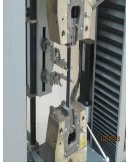
Şekil 2.12. Numunelerin çekme cihazına sabitlenmesi
