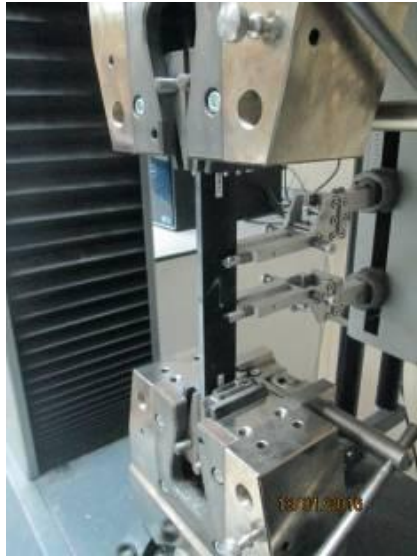
Şekil 2.12. Numunelerin çekme cihazına sabitlenmesi
