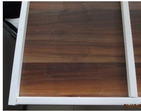
Şekil 2.7. Kalıp şekli ve 0.20 mm lik sac numune
