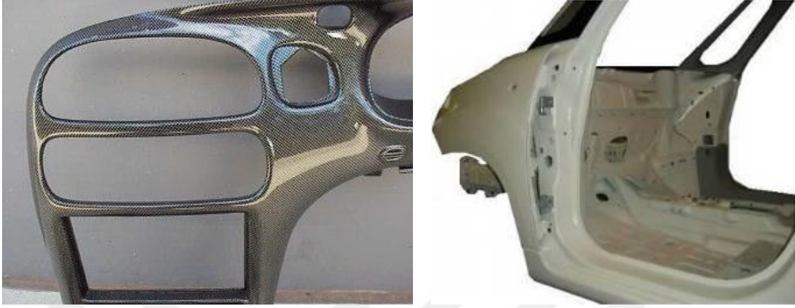
Şekil 1.16. Kompozit malzemeden yapılmış otomobil ön paneli ve araç gövdesi [61]
