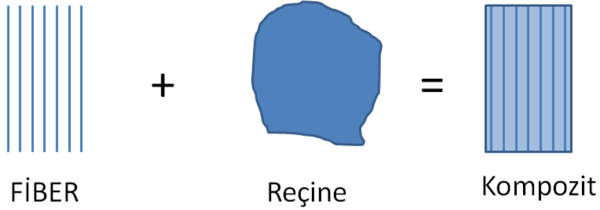
Şekil 1.2. Kompozit yapı oluşumu [44]
