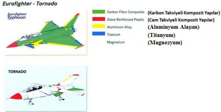
Şekil 1.14. Eurofighter ve Tornadoda kompozit parça dağılımları [58].
