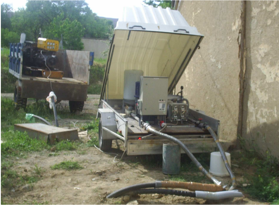
Şekil 4.1. Isıl duyarlılık testi (IDT) cihazı
