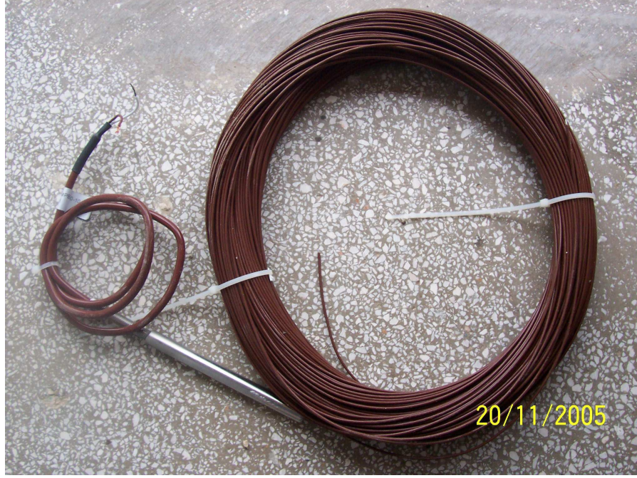
Şekil 3.19. Toprağa yerleştirilen ısıtıcı çift probleminin görünümü
