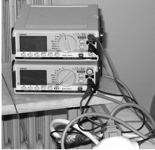
Şekil 5.4. Sistemde kullanılan gerilim ve akım ölçerler
