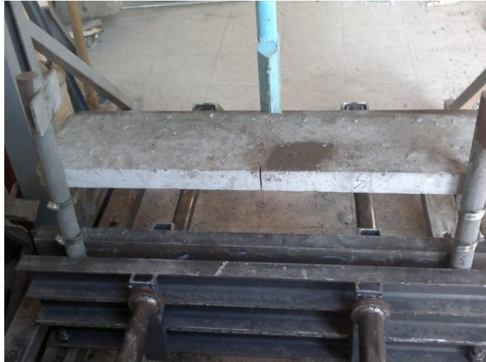
Şekil 5.13. Charpy deney düzeneği ve numunenin yerleştirilmesi
