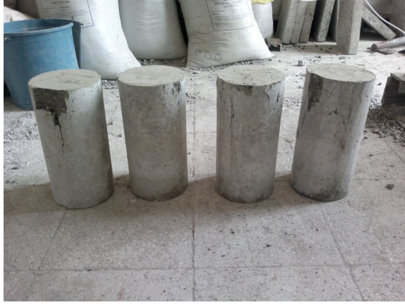
Şekil 5.5. Basınç dayanımı sonucunda numunenin kırılma şekli
