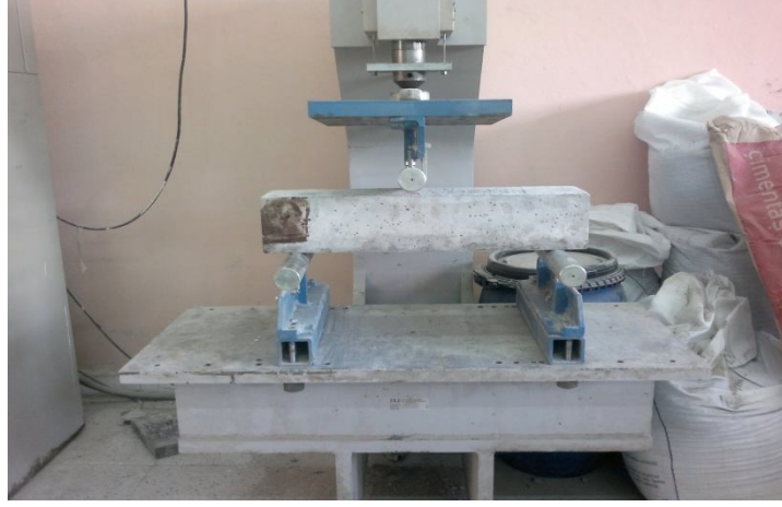
Şekil 5.6. Eğilme yükü altında kırılma deney düzeneği
