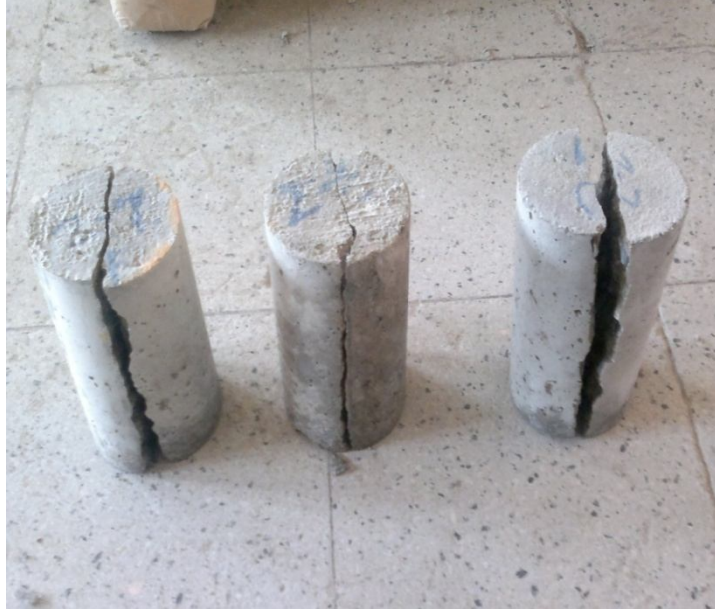
Şekil 5.10. Yarmada çekme numunesinin kırılma şekli
