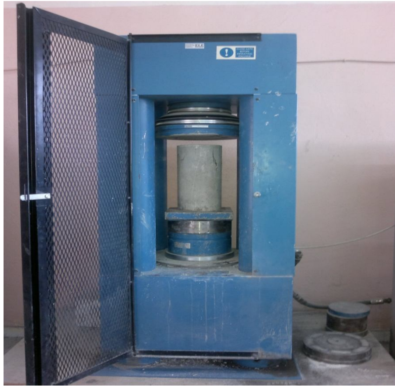
Şekil 5.4. Basınç dayanımı deney düzeneği
