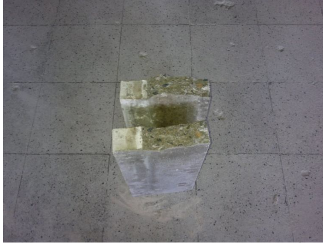
Şekil 5.15. Charpy deney düzeneğinde numunenin kırılma şekli
