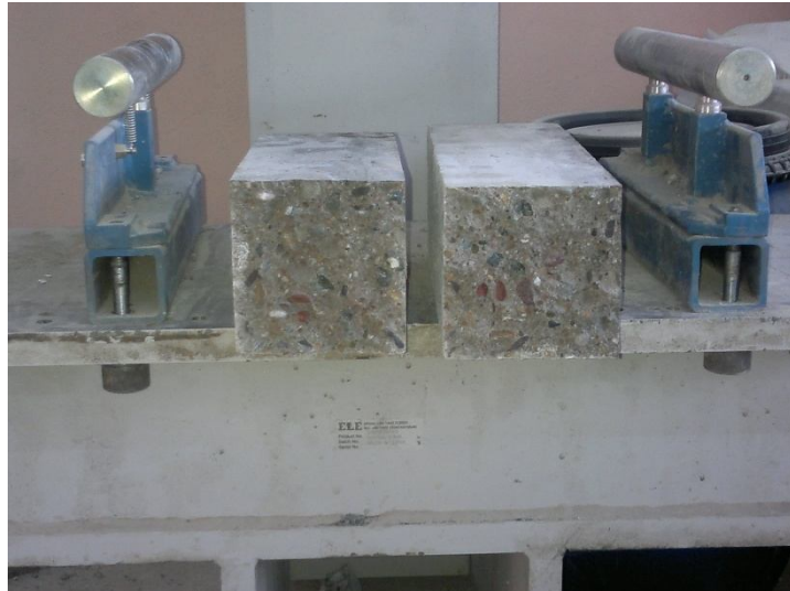
Şekil 5.8. Eğilme yükü altında numunenin kırılma şekli
