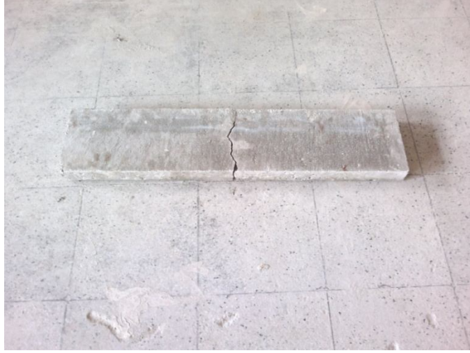
Şekil 5.14. Charpy deney düzeneğinde numunenin kırılma şekli
