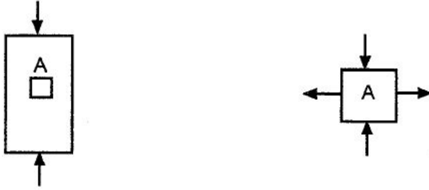
Şekil 3.3. Basınç yükü nedeniyle oluşan çekme kuvveti
