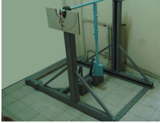
Şekil 5.11. Charpy deney düzeneği ve numunenin yerleştirilmesi
