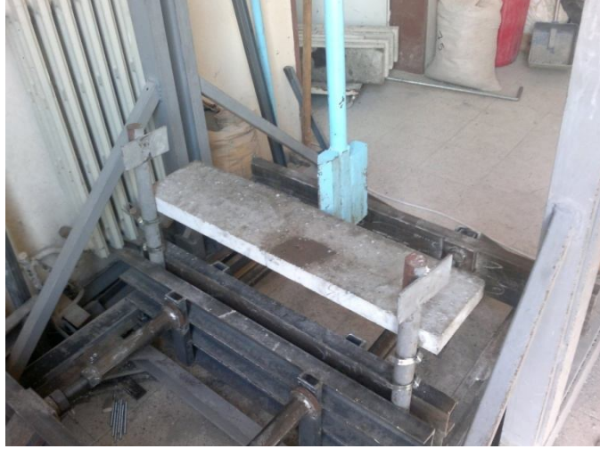
Şekil 5.12. Charpy deney düzeneği ve numunenin yerleştirilmesi
