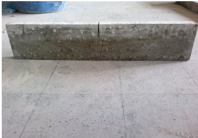
Şekil 5.16. Charpy deney düzeneğinde numunenin kırılma şekli
