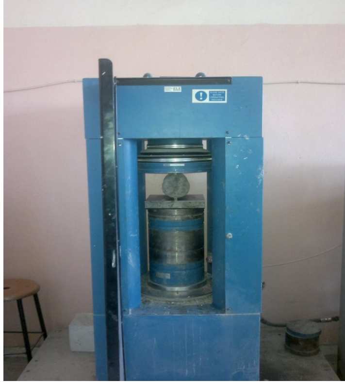
Şekil 5.9. Yarmada çekme deney düzeneği
