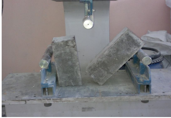
Şekil 5.7. Eğilme yükü altında numunenin kırılma şekli
