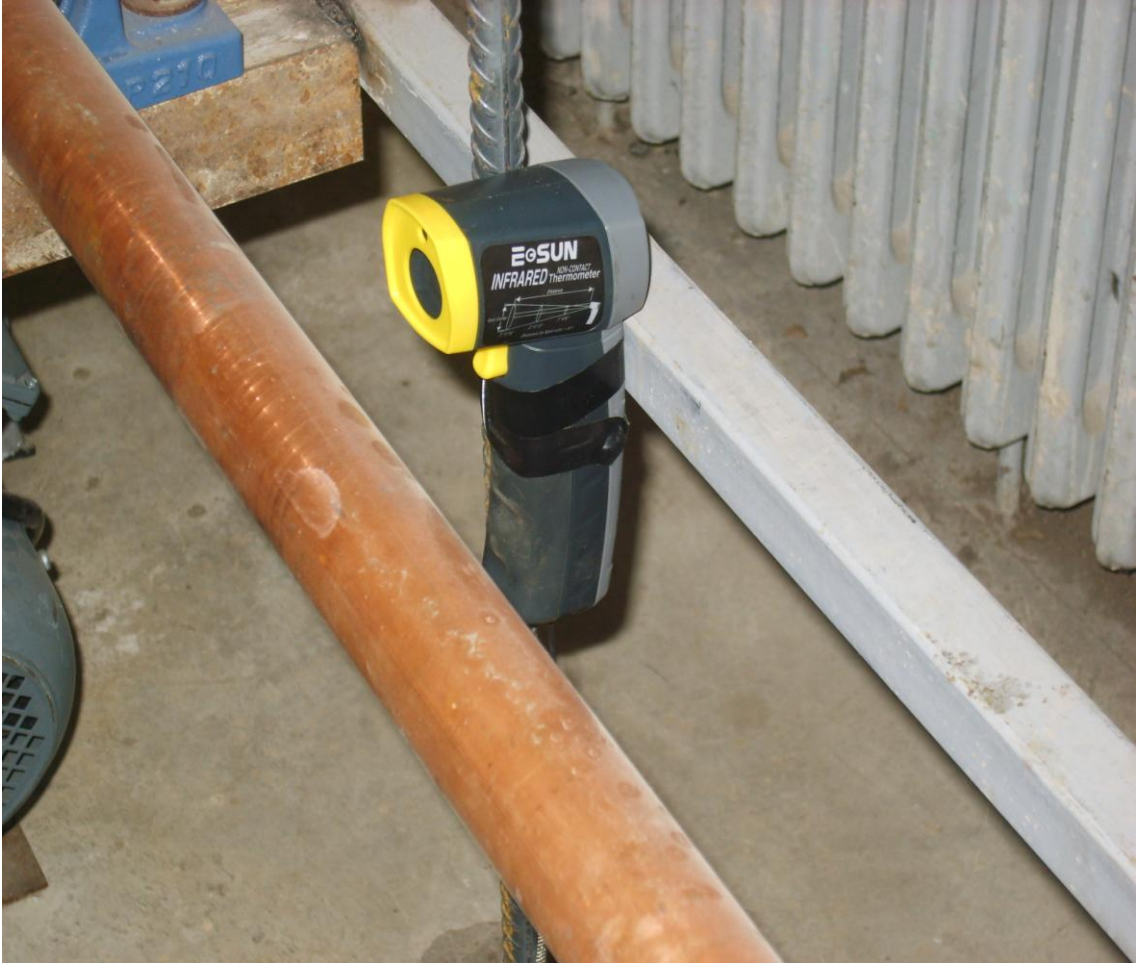
Şekil 4.1. İnfrared sıcaklık ölçerin döner borudaki sıcaklığı ölçmesi için hazırlanan düzenek
