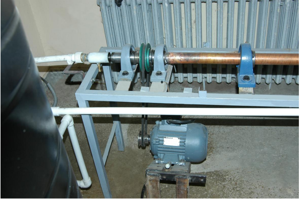
Şekil Ek 1.2 Isı transferi deney düzeneğinde borunun yataklanması ve kayış kasnak sistemiyle tahrik edilmesi
