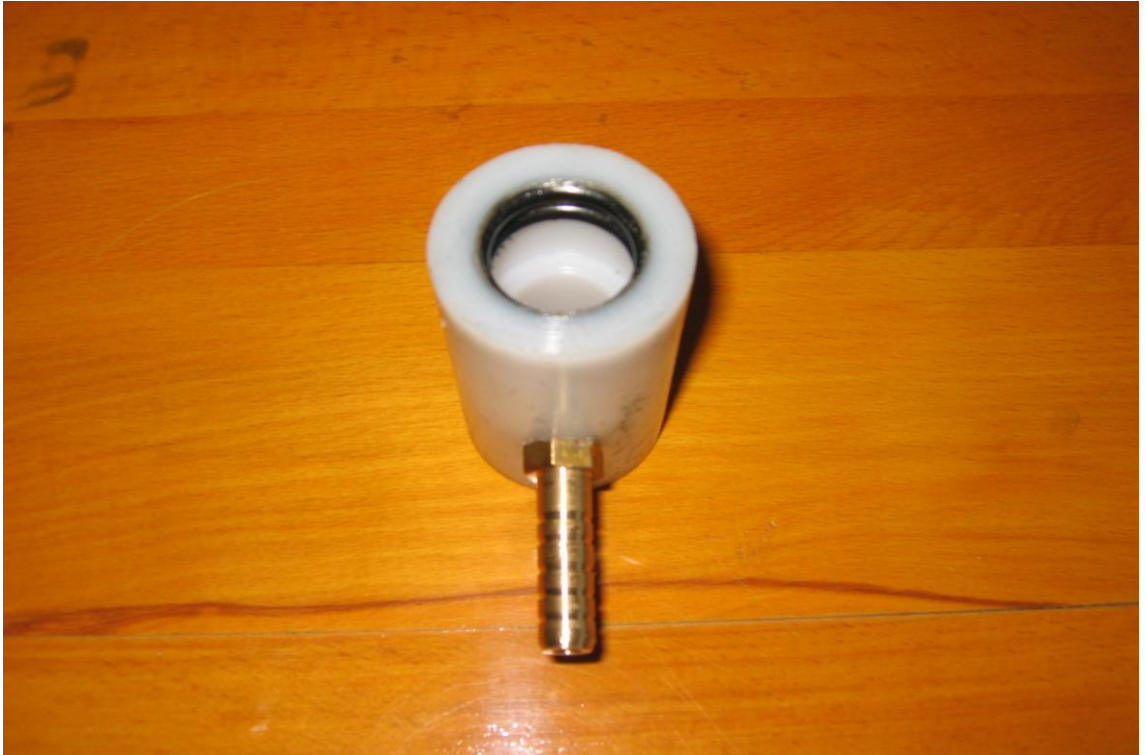
Şekil Ek 1.4 Isı Transferi deney düzeneğinde basınç prizi ve sızdırmazlığı sağlayan halka contalar
