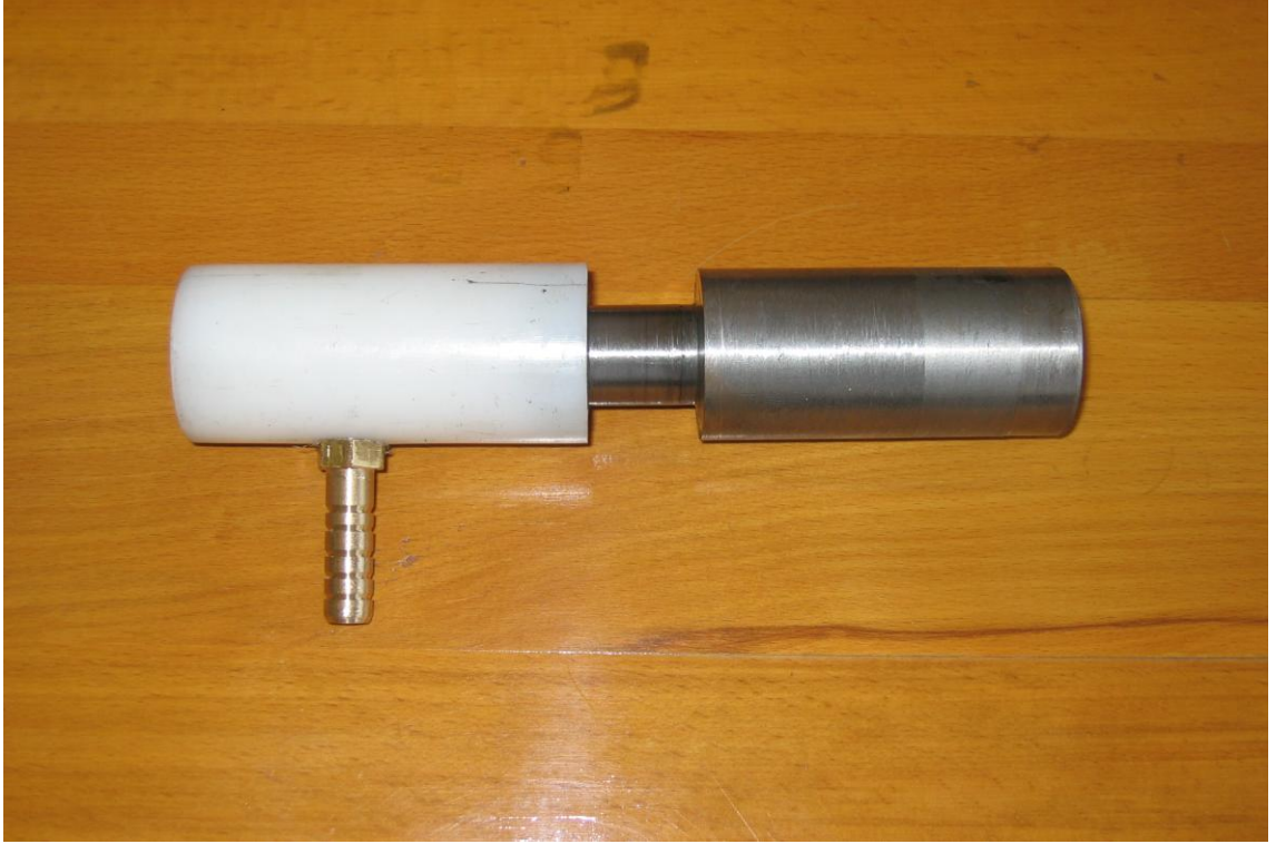
Şekil Ek 1.3 Isı transferi deney düzeneğinde sızdırmazlığın sağlanması
