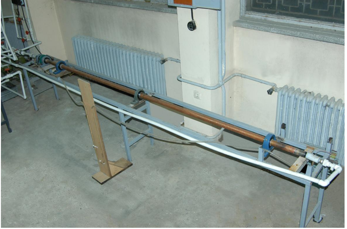
Şekil 3.1 Dönen bakır borunun görünüşü
