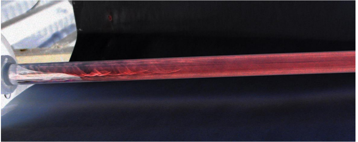
Şekil 7.34 Re=500 ve n=400 dev/dak. değerlerindeki laminar akışın boru içinde ilerlemesi
