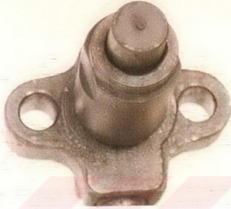
Resim 5.49. Motorin ile 100 Saatlik Çalışma Sonunda Enjektörün Görünüşü.
