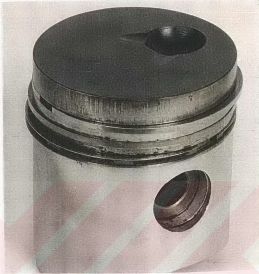
Resim 5.45. Motorin ile 100 Saatlik Çalışma Sonunda Piston Üst Yüzeyinin Görünüşü.
