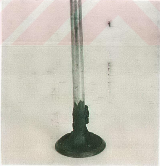
Resim 5.74. %75 Pamuk Yağı + %25 Motorin ile 100 Saatlik Çalışma Sonunda Emme Supabının Görünüşü.
