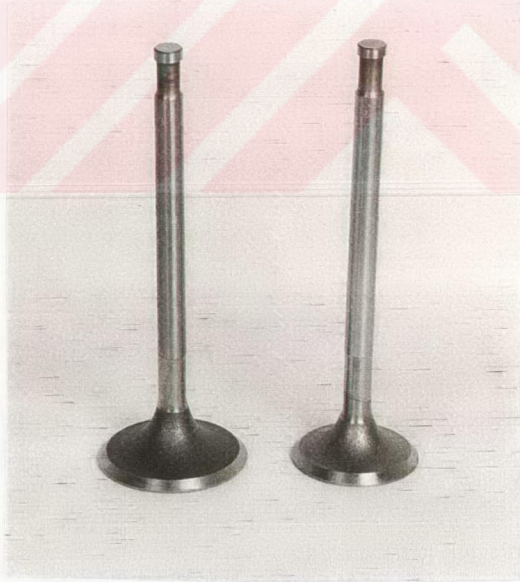
Resim 5.36. Emme ve Egzoz Supabının Deneyler Yapılmadan Önceki Görünüşü.
