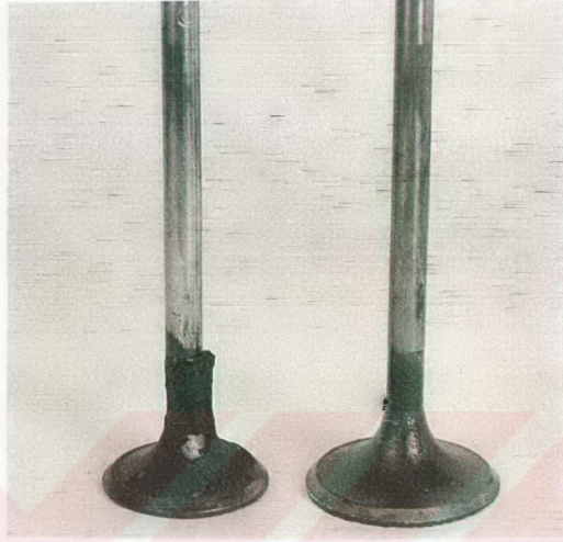
Resim 5.73. %75 Pamuk Yağı + %25 Motorin ile 100 Saatlik Çalışma Sonunda Emme ve Egzoz Supabının Görünüşü.
