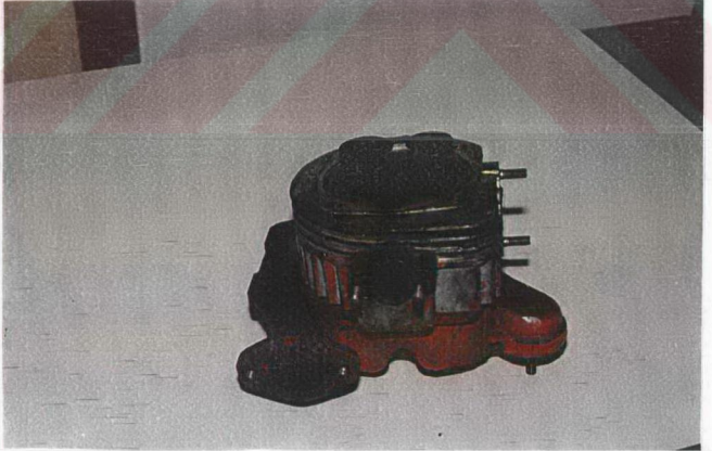
Resim 5.52. %25 Pamuk Yağı + %75 Motorin ile 100 Saatlik Çalışma Sonunda Yanma Odası ve Supapların Görünüşü.
