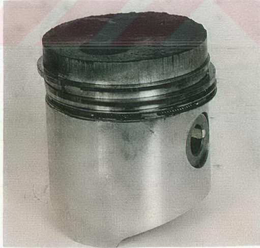
Resim 5.63. %50 Pamuk Yağı + %50 Motorin ile 100 Saatlik Çalışma Sonunda Pistonun Görünüşü.
