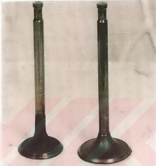
Resim 5.53. %25 Pamuk Yağı + %75 Motorin ile 100 Saatlik Çalışma Sonunda Emme ve Egzoz Supabının Görünüşü.
