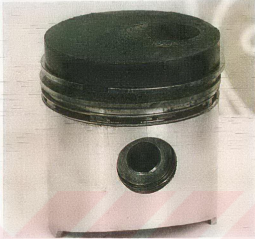
Resim 5.71. %75 Pamuk Yağı + %25 Motorin ile 100 Saatlik Çalışma Sonunda Pistonun Görünüşü.
