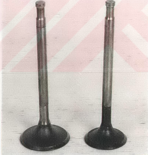
Resim 5.44. Motorin ile 100 Saatlik Çalışma Sonunda Emme ve Egzoz Supabının Görünüşü.
