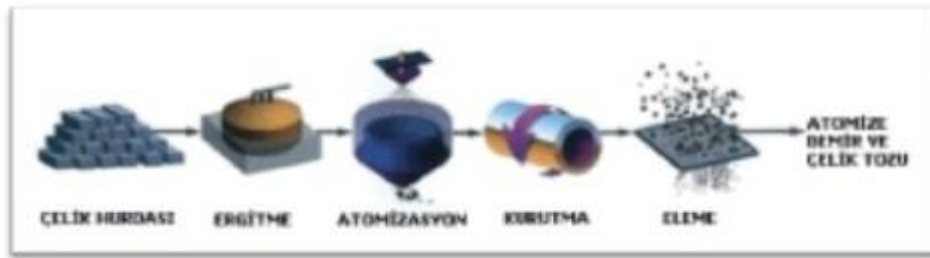
Şekil 2.6. Su Atomizasyonu Tekniği ile Toz Üretimi
