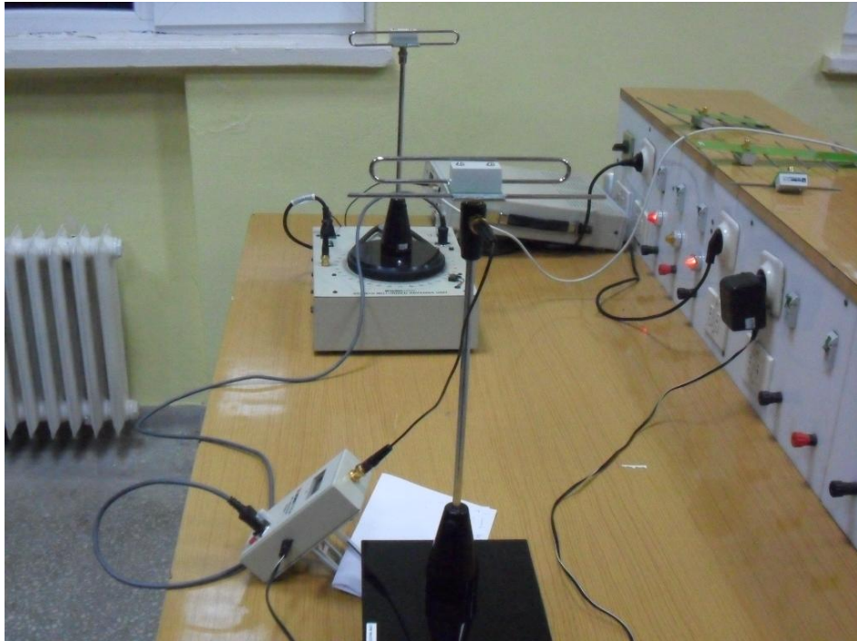
Şekil 5.5. Anten deney seti
