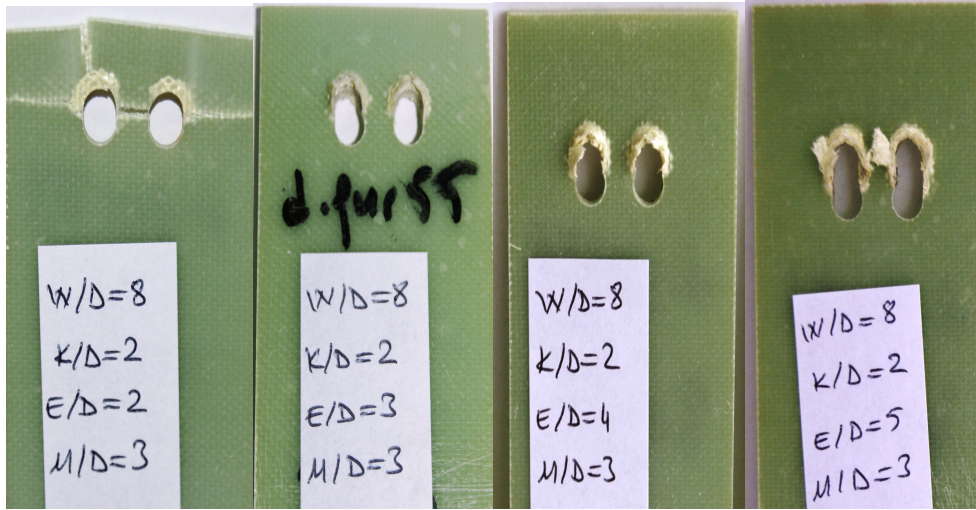
Şekil 3.94. 6 ay deniz suyunda bekletilen W=40 mm, K=10 mm, M=15 mm ve E=10, 15, 20, 25 mm ölçülerindeki numunelerin hasar fotoğrafları
