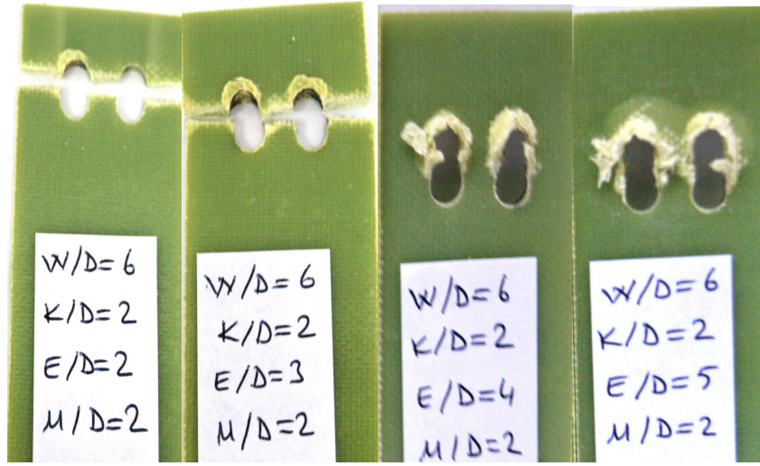
Şekil 3.72. Kuru halde W=30 mm, K=10 mm, M=10 mm ve E=10, 15, 20, 25 mm ölçülerindeki numunelerin hasar fotoğrafları
