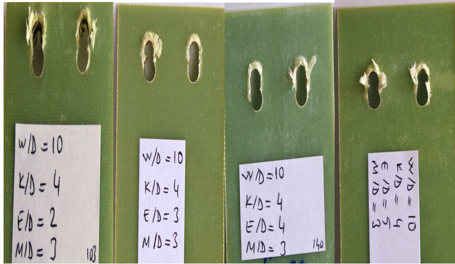
Şekil 3.102. Kuru halde W=50 mm, K=20 mm, M=15 mm ve E=10, 15, 20, 25 mm ölçülerindeki numunelerin hasar fotoğrafları
