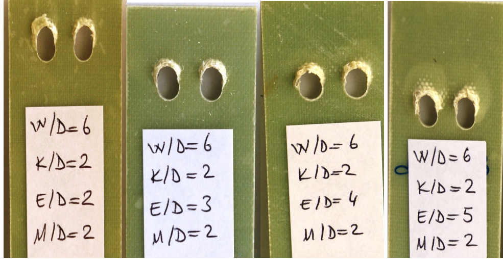
Şekil 3.74. 3 ay deniz suyunda bekletilen W=30 mm, K=10 mm, M=10 mm ve E=10, 15, 20, 25 mm ölçülerindeki numunelerin hasar fotoğrafları
