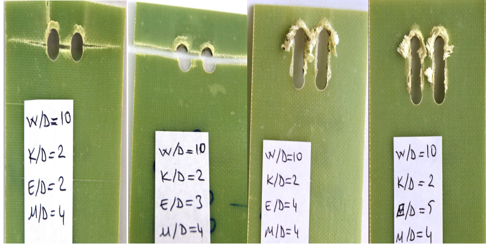
Şekil 3.108. Kuru halde W=50 mm, K=10 mm, M=20 mm ve E=10, 15, 20, 25 mm ölçülerindeki numunelerin hasar fotoğrafları
