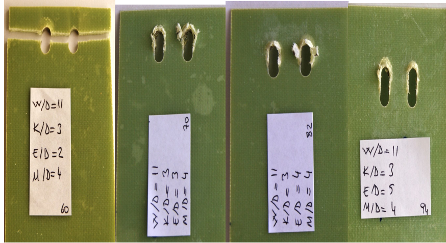
Şekil 3.114. Kuru halde W=55 mm, K=15 mm, M=20 mm ve E=10, 15, 20, 25 mm ölçülerindeki numunelerin hasar fotoğrafları
