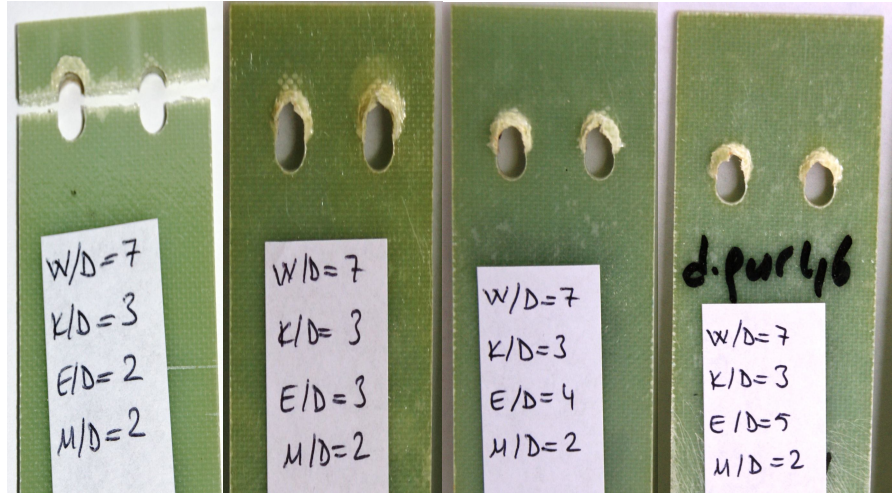
Şekil 3.82. 6 ay deniz suyunda bekletilen W=35 mm, K=15 mm, M=10 mm ve E=10, 15, 20, 25 mm ölçülerindeki numunelerin hasar fotoğrafları
