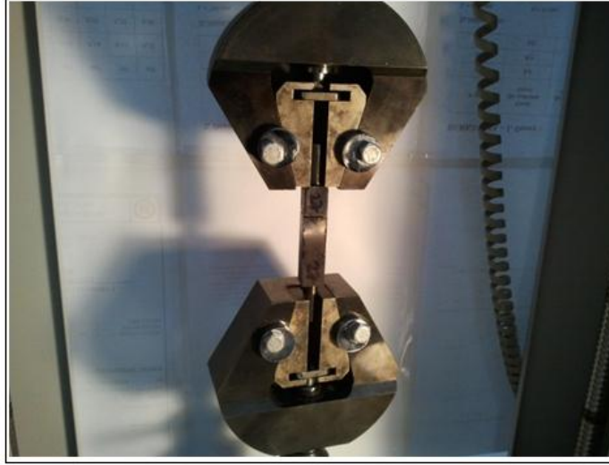
Şekil 2.13. Deney numunesinin test cihazına bağlanması
