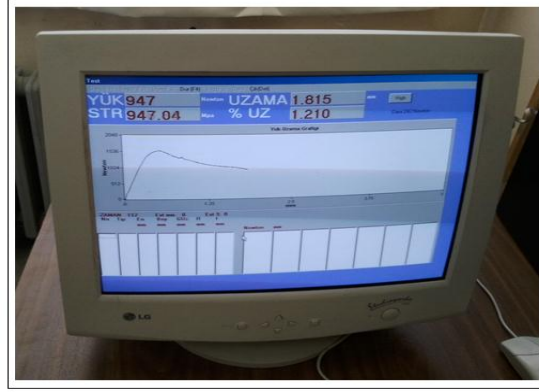
Şekil 2.15. Çekme deneyi verilerinin alınması
