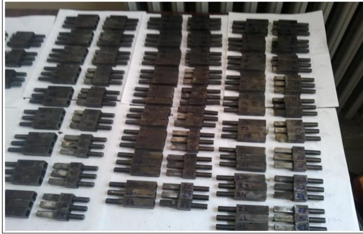
Şekil 2.16. Çekme deneyi gerçekleştirilmiş numuneler
