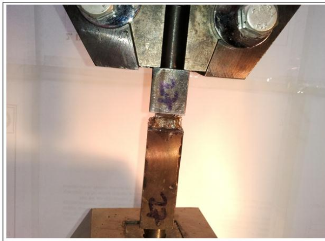
Şekil 2.14. Çekme deneyi sırasında yapıştırma bağlantısının kopması
