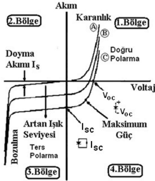
Şekil 3.5. Foto diyotun karanlık ve aydınlatılmış durumlardaki akım-voltaj karakteristikleri [3].
