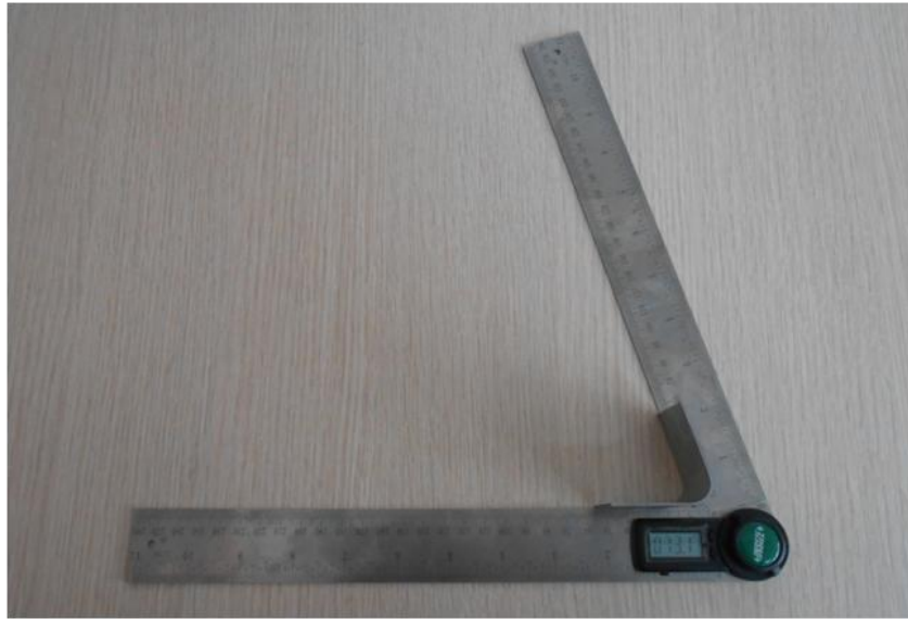
Şekil 3.8. Dijital açı ölçer yardımıyla açı ölçümünün yapılması
