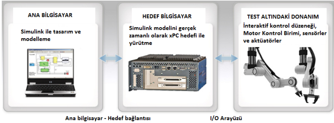
Şekil 3.4 Simulink® gerçek zamanlı test düzeneği [19]
