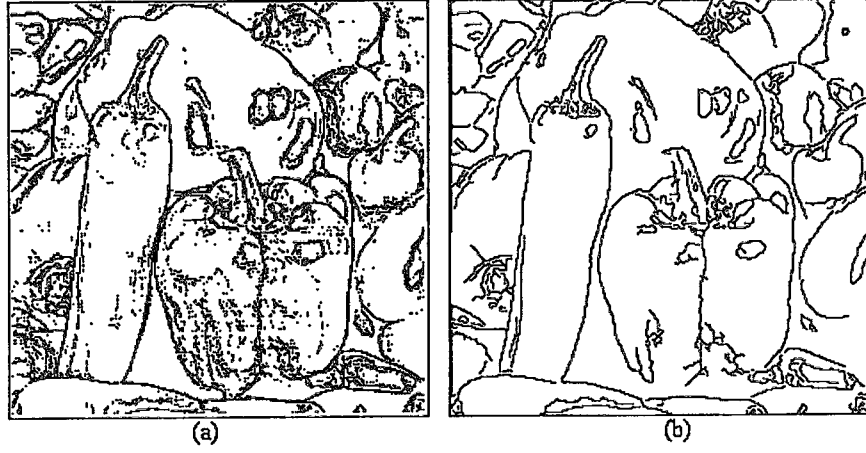
Şekil 6.4 Biber görüntüsü için (a) MYSA'nın kenar sonucu ( its=100 , R=6 , lr=0.01 ) (b) Canny algoritmasının kenar sonucu ( \alpha=0.5 , t_1=5 , t_2=20 ).
