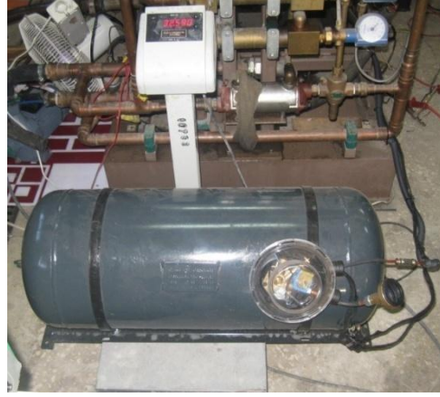
Şekil 2.9. LPG ve Benzin için yakıt tüketim miktarlarının belirlenmesinde kullanılan düzenekler.
