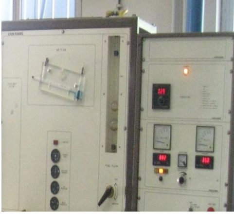
Şekil 2.9. LPG ve Benzin için yakıt tüketim miktarlarının belirlenmesinde kullanılan düzenekler.
