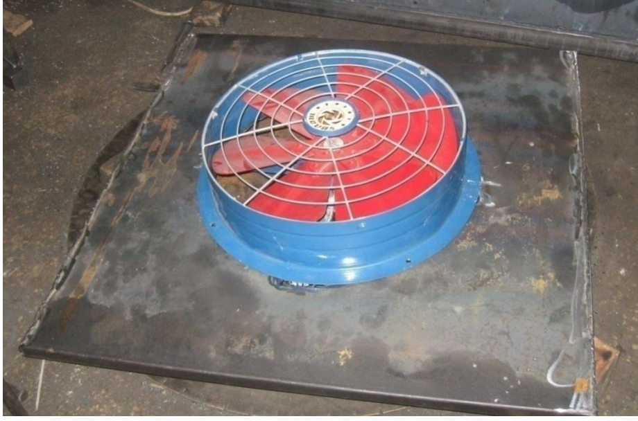
Şekil 2.4. Soğutma kulesi hava emiş fanı imalat görüntüsü
