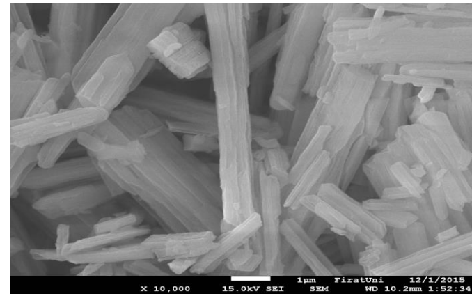
Şekil Ek 4.4.24. K:Mg:P oranı 1:1:1 olacak şekilde pH 9.5’da çöktürülen potasyum-struvit içerikli ürünlerin SEM görüntüleri (Çöktürme işlemindeki diğer şartlar: süre, 24 ve 120 saat; sıcaklık, oda sıcaklığında )(Tablo 4.4.4’de ki 3 ve 5 nolu örnekler).
