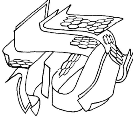
Şekil 2.4.4. Aktif karbonun mikroporlarının yapısı (Stoeckli, 1990).
