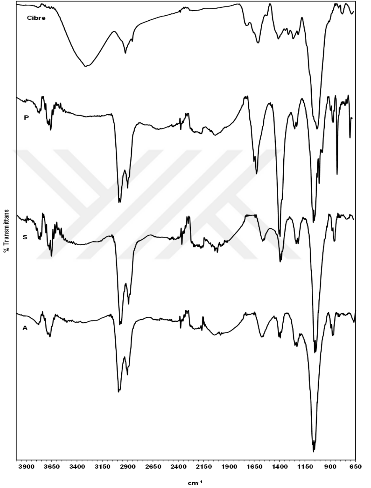
Şekil 4.3.8. Cibrenin 600°C’deki piroliz ürünü, onun su ekstraksiyon kalıntısı ve asit çözeltisiyle yıkama sonunda elde edilen aktif karbonun FTIR spektrumları.
