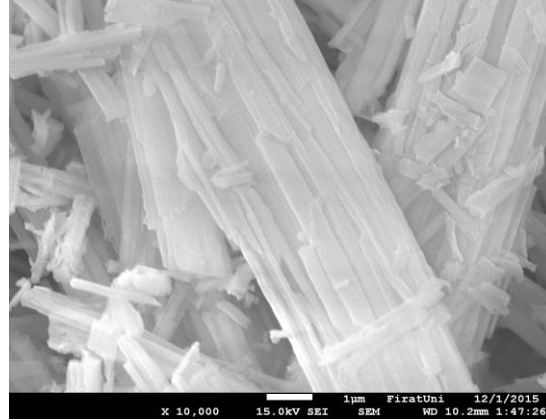
Şekil Ek 4.4.14. K:Mg:P oranı 1:1:1 olacak şekilde pH 9.5, 10, 10.5’da çöktürülen potasyum-struvit içerikli ürünlerin SEM görüntüleri (Çöktürme işlemindeki diğer şartlar: süre, 6 saat; sıcaklık, oda sıcaklığı) (Tablo 4.4.3’de ki 6, 7 ve 8 nolu örnekler).
