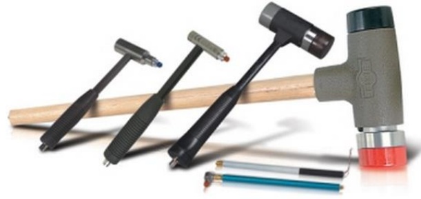
Şekil 3.6. Farklı modellerdeki darbe çekiçleri [44]
