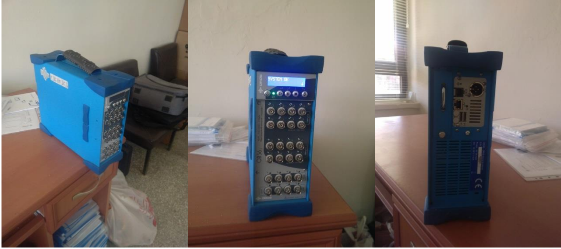
Şekil 3.9. OROS-OR36 Çok Kanallı Gürültü ve Titreşim Analizörü
