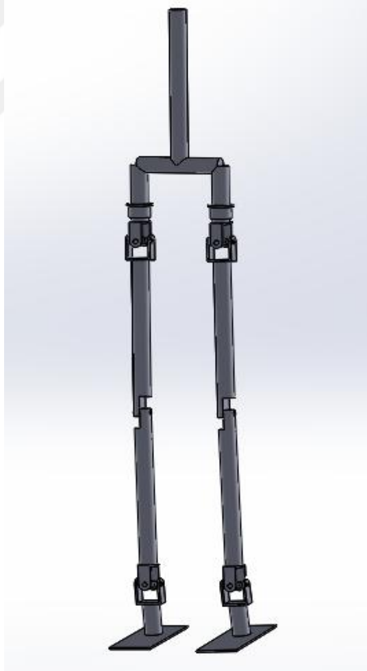
Şekil 5.1. İki ayaklı yürüyen robotun katı modeli
