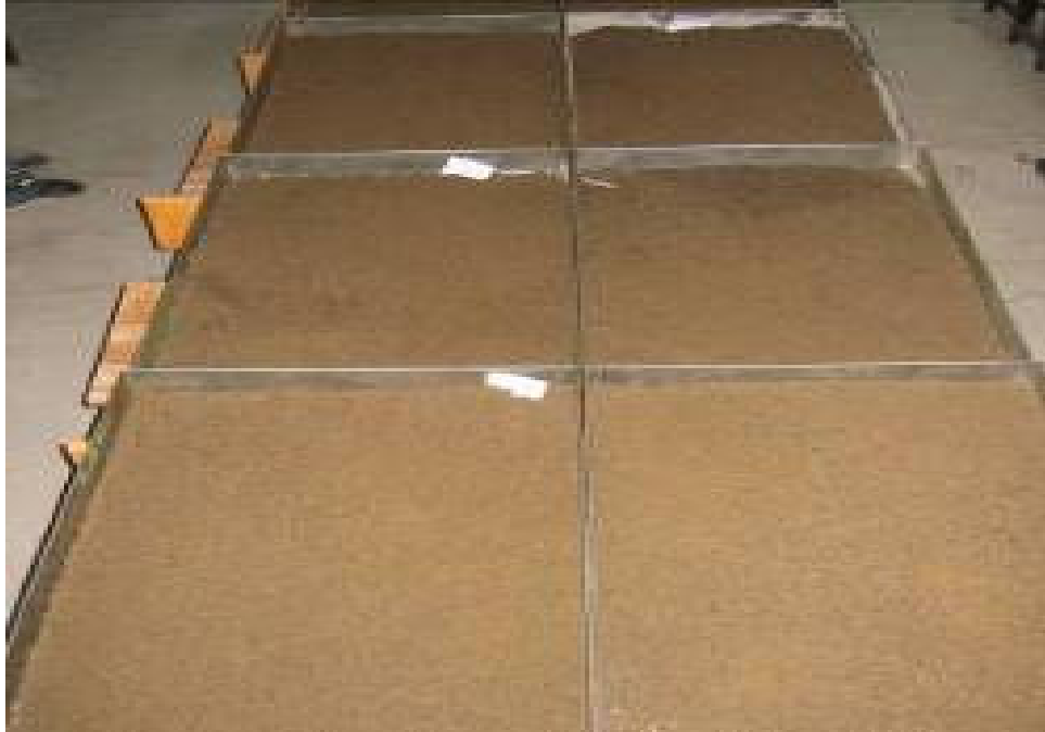
Şekil 3.3. Peletlenmiş yemlerin kurutma fırını tepsilerine yerleştirilmesi
