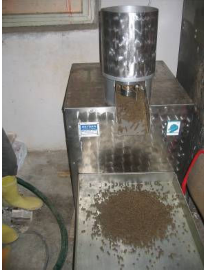
Şekil 3.2. Hamur halindeki yemin pelet makinesinde peletlenmesi
