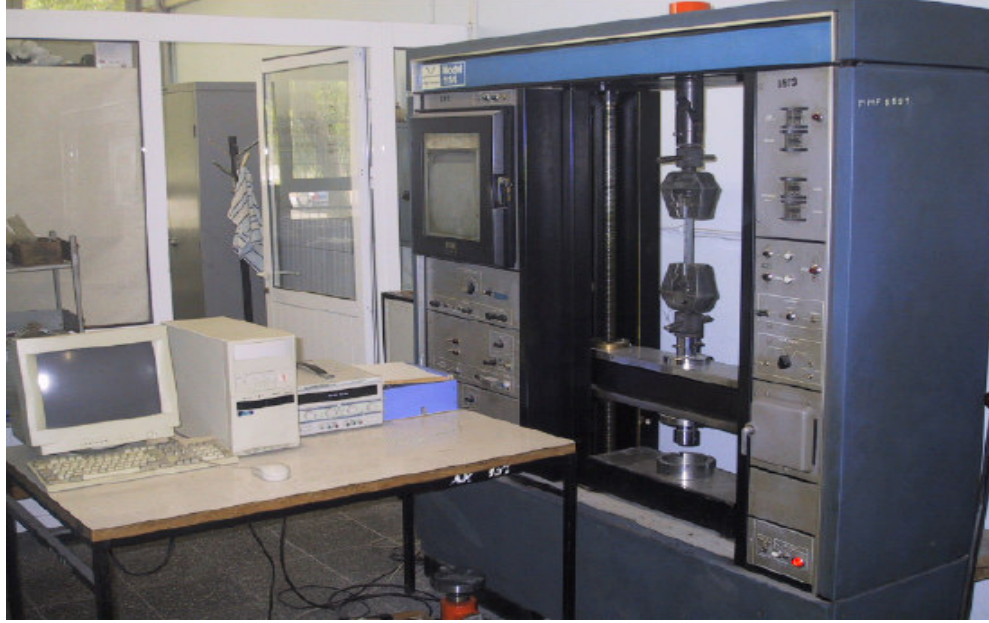
Şekil 4.2. Birinci bölüm numunelerin çekilmesinde kullanılan üniversal (INSTRON 1114) çekme cihazı
