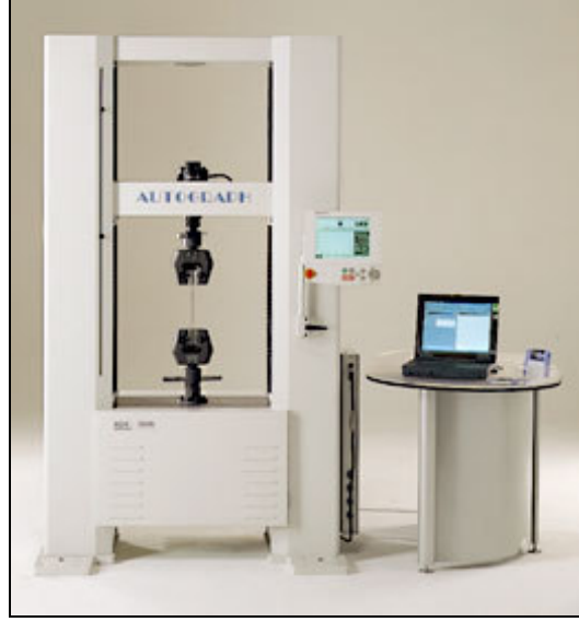
Şekil 4.3. İkinci bölüm numunelerin çekilmesinde kullanılan üniversal (SHIMADZU) çekme cihazı[87]
