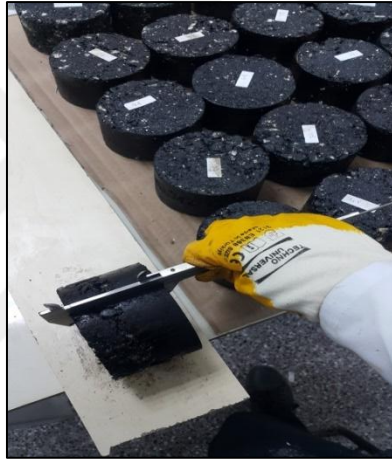
Şekil 2.5. Briket yüksekliklerinin belirlenmesi
