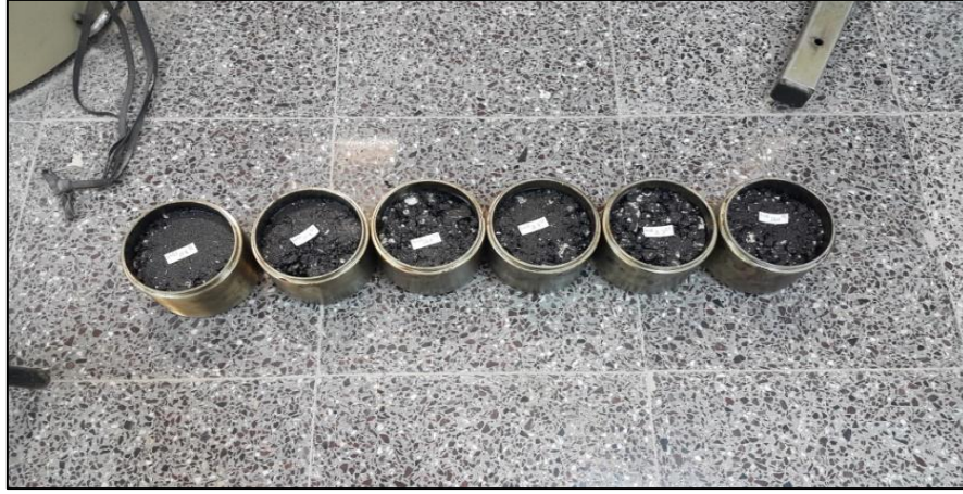
Şekil 2.3. Numunelerin kalıplardan çıkarılmadan önce etiketlenmesi ve bekletilmesi
