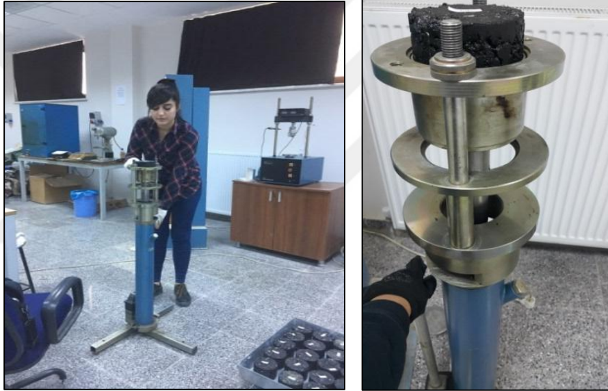
Şekil 2.4. Numunelerin kalıptan numune çıkarıcı yardımıyla çıkarılması
