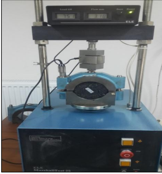
Şekil 2.7. Su banyosundan çıkarılan numunelerin Marshall stabilite aletinde kırılması
