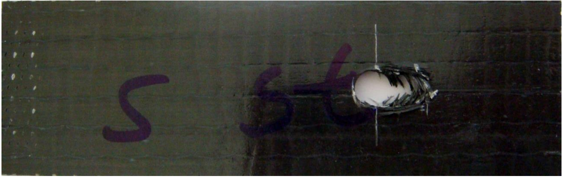
Şekil 6.48. [0^\circ/75^\circ/75^\circ/0^\circ] tabaka dizilimine sahip, hasara uğramış yamasız numune
