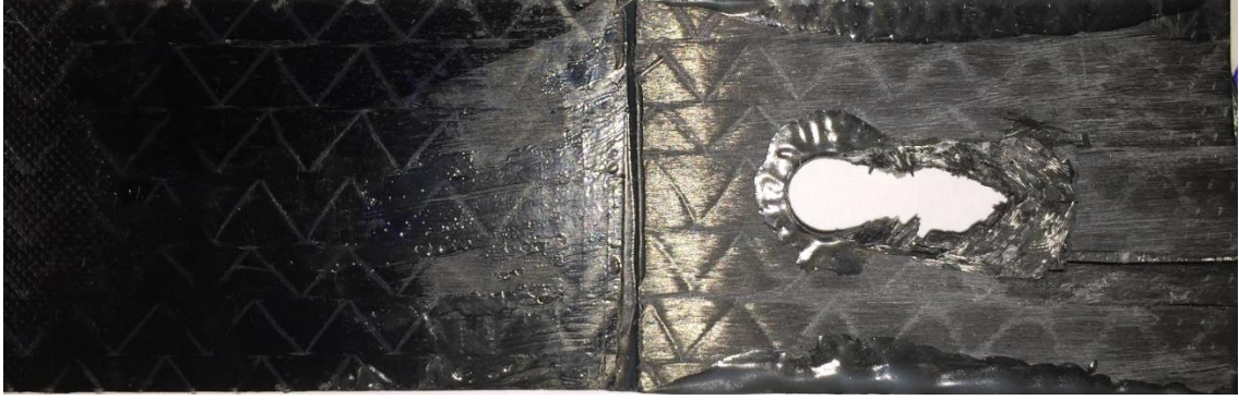
Şekil 6.53. [0^\circ/90^\circ/90^\circ/0^\circ] tabaka dizilimine sahip, hasara uğramış yamalı numune
