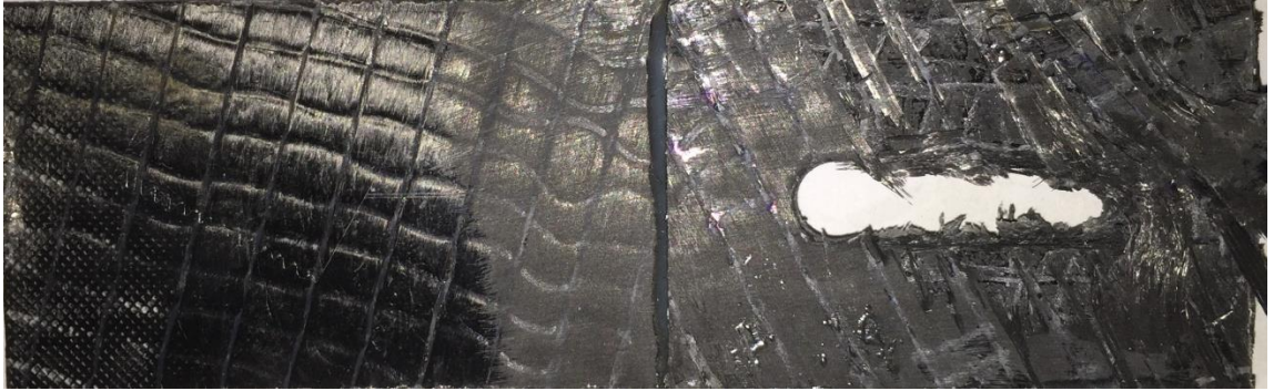
Şekil 6.50. [0^\circ/75^\circ/0^\circ/75^\circ] tabaka dizilimine sahip, hasara uğramış yamalı numune
