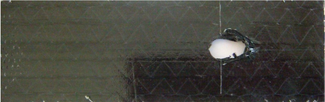
Şekil 6.42. [0^\circ/45^\circ/45^\circ/0^\circ] tabaka dizilimine sahip, hasara uğramış yamasız numune
