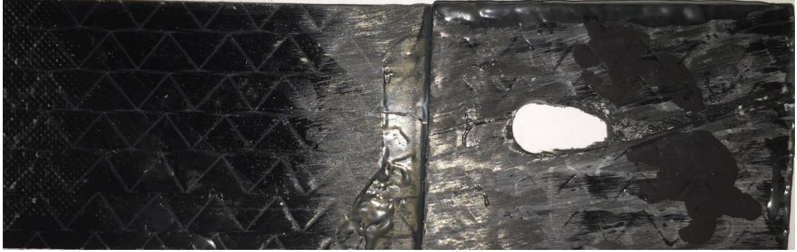
Şekil 6.32. [0^\circ/15^\circ/0^\circ/15^\circ] tabaka dizilimine sahip, hasara uğramış yamalı numune
