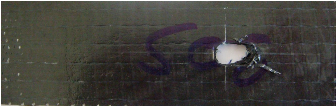
Sekil 6.36. [0^\circ/30^\circ/30^\circ/0^\circ] tabaka dizilimine sahip, hasara uğramış yamasız numune
