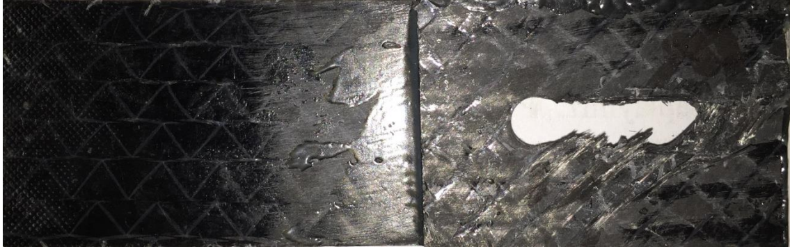
Şekil 6.44. [0^\circ/45^\circ/0^\circ/45^\circ] tabaka dizilimine sahip, hasara uğramış yamalı numune
