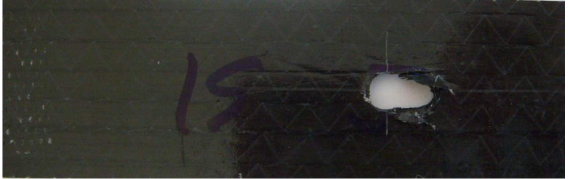
Şekil 6.30. [0^\circ/15^\circ/15^\circ/0^\circ] tabaka dizilimine sahip, hasara uğramış yamasız numune
