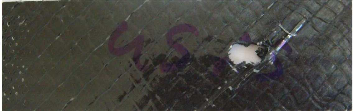
Şekil 6.45. [0^\circ/45^\circ/0^\circ/45^\circ] tabaka dizilimine sahip, hasara uğramış yamasız numune
