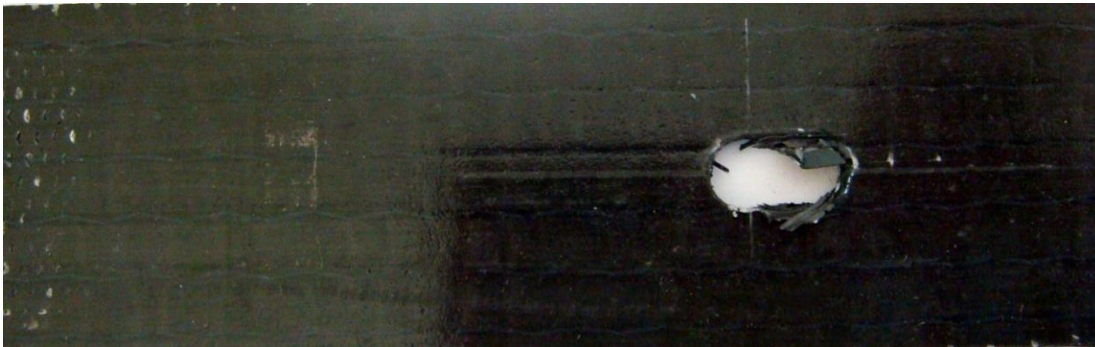
Şekil 6.27. [0^\circ/0^\circ/0^\circ/0^\circ] tabaka dizilimine sahip, hasara uğramış yamasız numune
