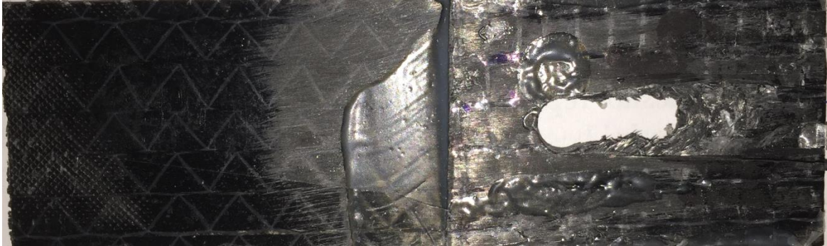
Şekil 7.34. [0^\circ/45^\circ/45^\circ/0^\circ] tabaka dizilimine sahip kompozit levhada deneysel çalışma sonucu meydana gelen hasarın görüntüsü
