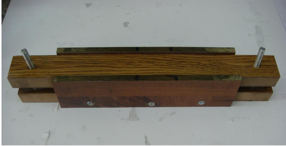
Şekil 6.9. Sabit bir yapıştırıcı kalınlığı oluşturmak için kullanılan kalıp
