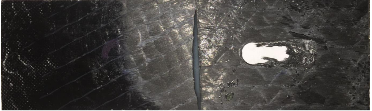
Şekil 7.32. [0^\circ/30^\circ/0^\circ/30^\circ] tabaka dizilimine sahip kompozit levhada deneysel çalışma sonucu meydana gelen hasarın görüntüsü
