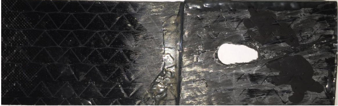
Şekil 7.28. [0^\circ/15^\circ/0^\circ/15^\circ] tabaka dizilimine sahip kompozit levhada deneysel çalışma sonucu meydana gelen hasarın görüntüsü
