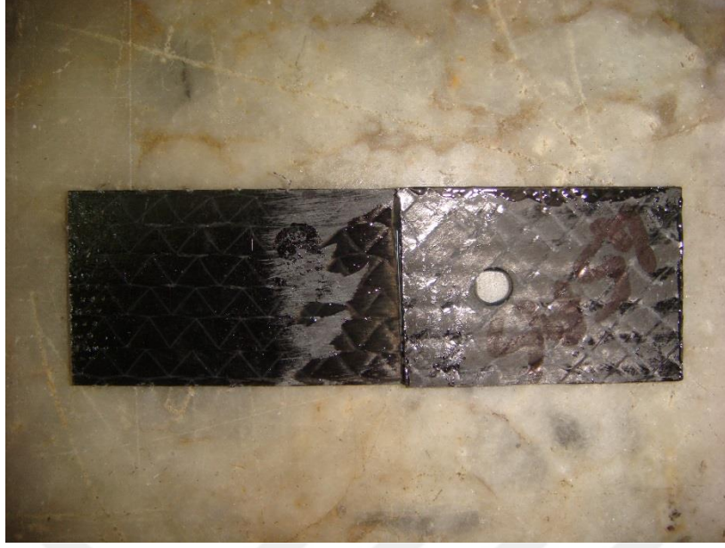
Şekil 6.11. Yama yapılarak onarılmış numune
