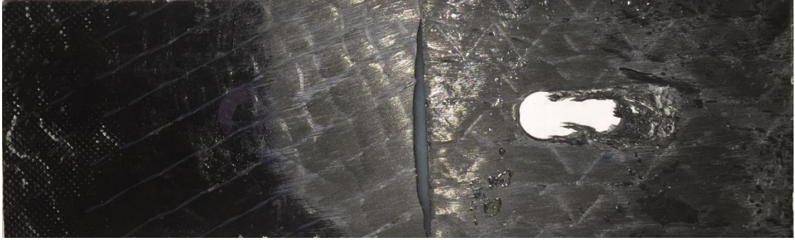
Şekil 6.38. [0^\circ/30^\circ/0^\circ/30^\circ] tabaka dizilimine sahip, hasara uğramış yamalı numune
