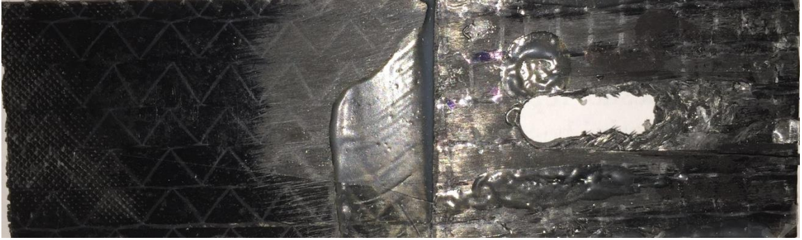
Şekil 6.41. [0^\circ/45^\circ/45^\circ/0^\circ] tabaka dizilimine sahip, hasara uğramış yamalı numune
