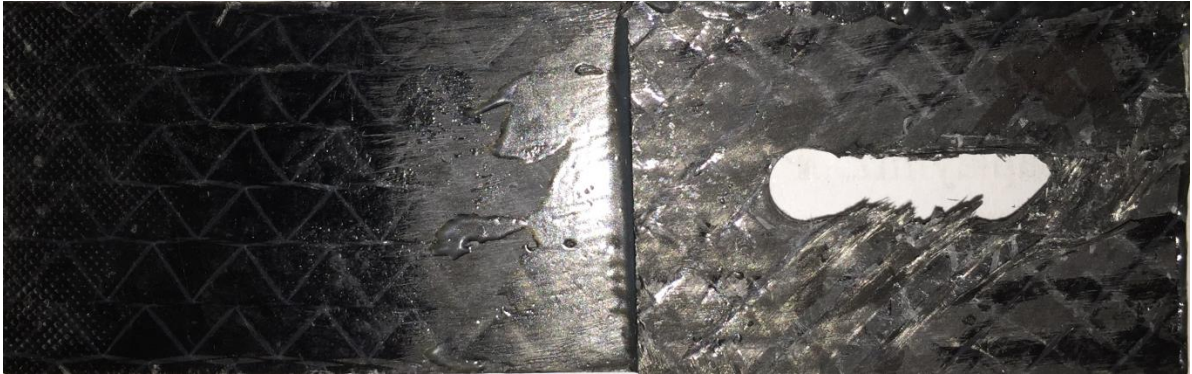
Şekil 7.36. [0^\circ/45^\circ/0^\circ/45^\circ] tabaka dizilimine sahip kompozit levhada deneysel çalışma sonucu meydana gelen hasarın görüntüsü
