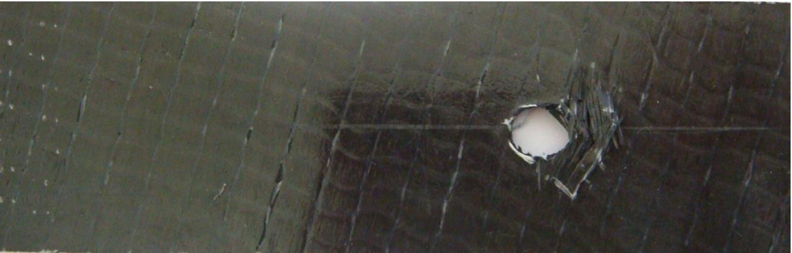
Şekil 6.51. [0^\circ/75^\circ/0^\circ/75^\circ] tabaka dizilimine sahip, hasara uğramış yamasız numune
