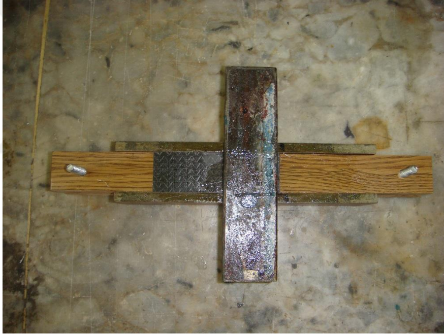
Şekil 6.10. Yapıştırma işleminin ağırlıkla desteklenmesi
