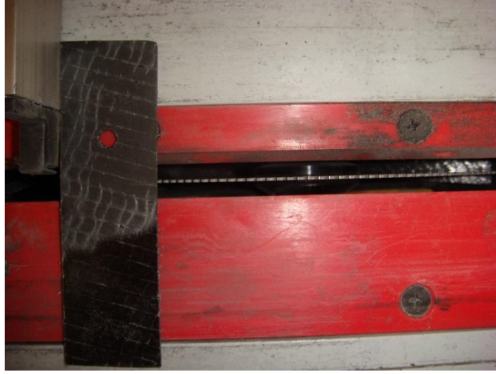
Şekil 6.6. Testere ile yama kesme işlemi
