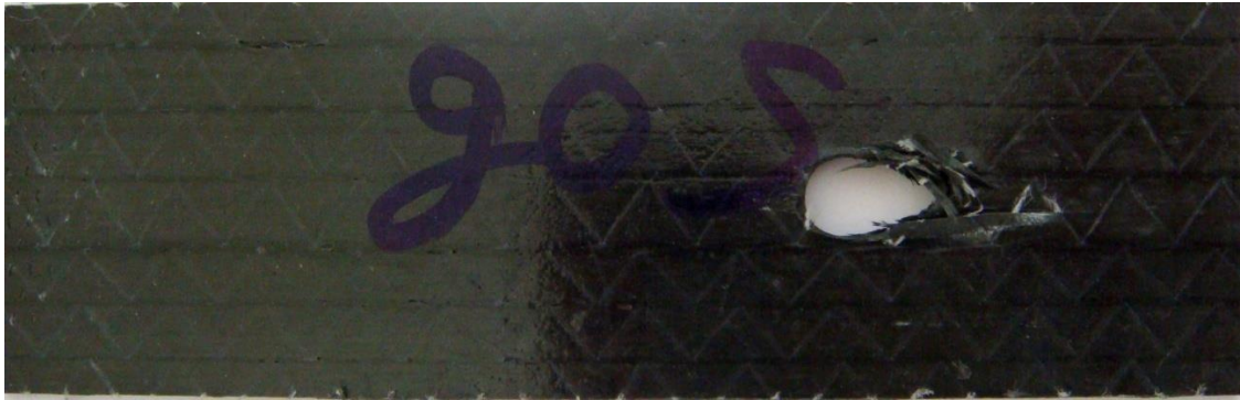
Şekil 6.54. [0^\circ/90^\circ/90^\circ/0^\circ] tabaka dizilimine sahip, hasara uğramış yamasız numune
