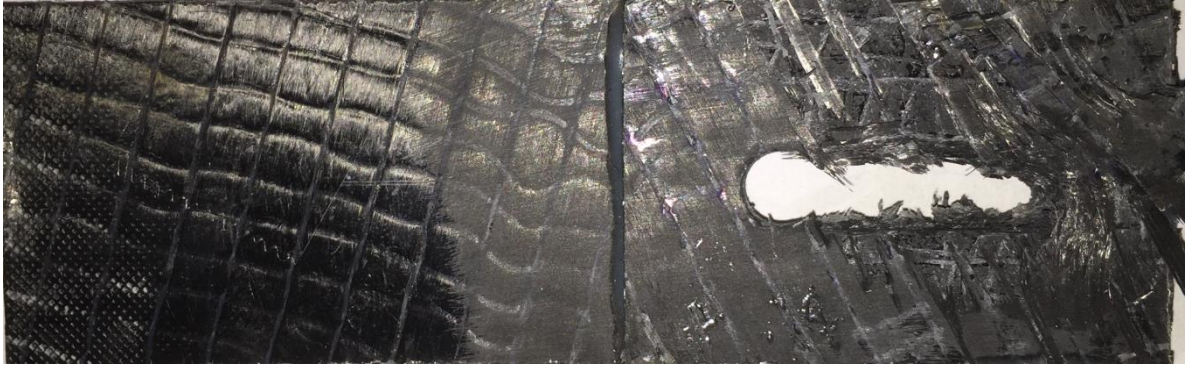
Şekil 7.40. [0^\circ/75^\circ/0^\circ/75^\circ] tabaka dizilimine sahip kompozit levhada deneysel çalışma sonucu meydana gelen hasarın görüntüsü
