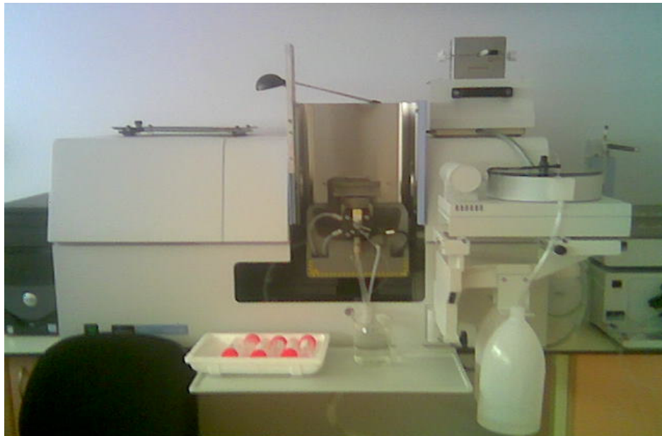
Şekil 3.4. Perkin-Elmer 800 analyst atomik absorpsiyon spektrometre cihazının fotoğrafı
