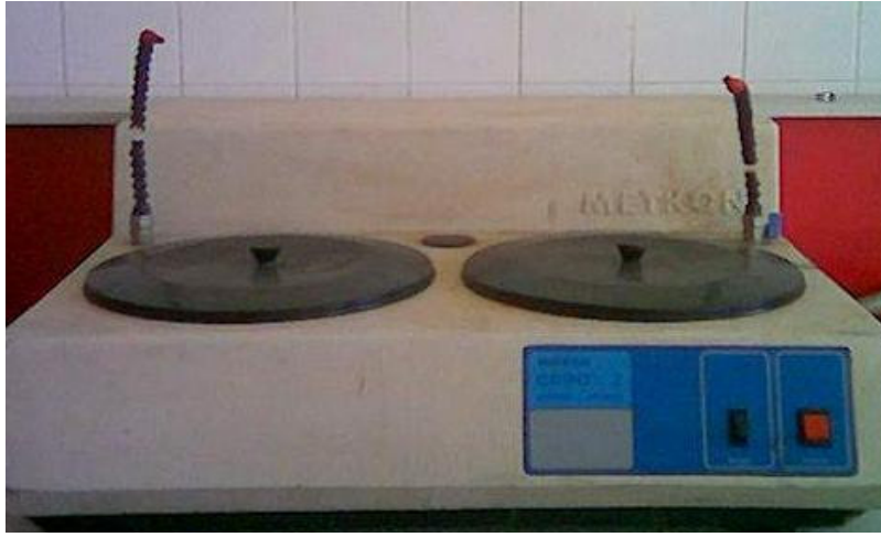
Şekil 3.5. Metkon numune parlatma makinesinin fotoğrafı.
