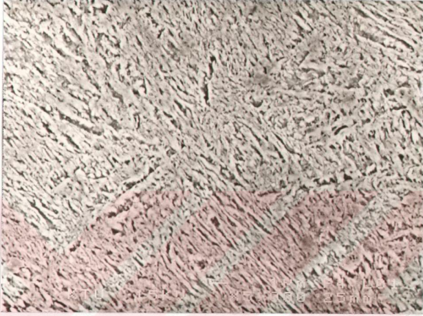
Resim 4. 400 °C de temperlenmiş numunelerin mikroyapısı ( \times 5000 )
