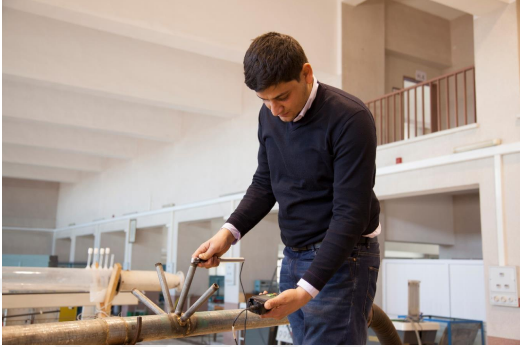
Şekil 4.8. Deney düzeneğinde hava giriş hızı ölçümü
