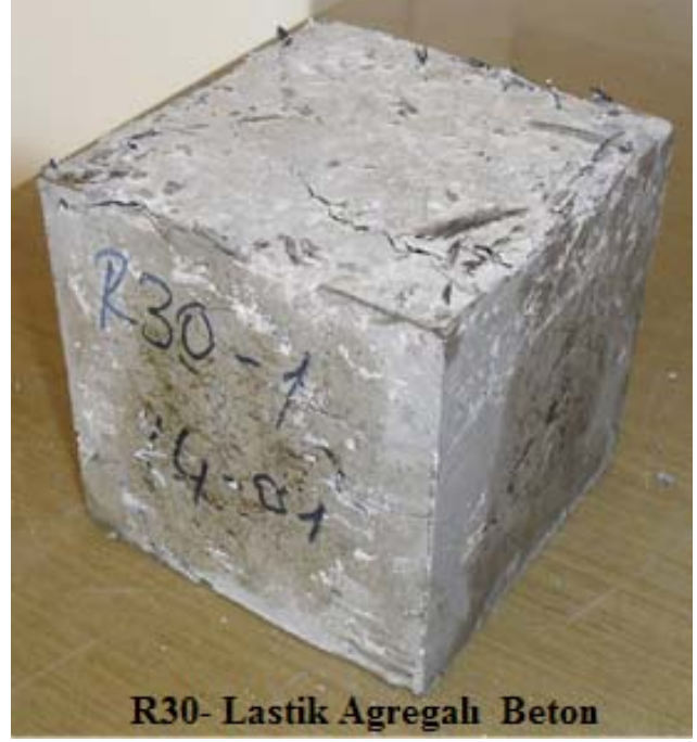
Şekil 7.10. Basınç dayanımı sonrası numunelerde oluşan kırılma yüzeyleri
