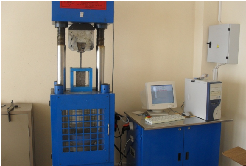
Şekil 6.17. Çekip çıkarma deney düzeneği
