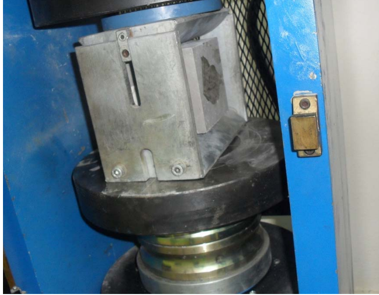
Şekil 6.15. Yarmada çekme deneyi
