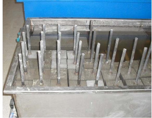
Şekil 6.6. Kür tankında bekletilen numunelerden bir görünüş
