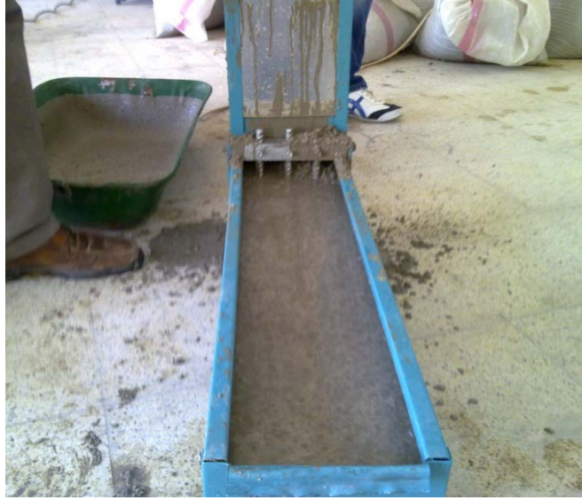
Şekil 6.9. L-kutusu deney aleti
