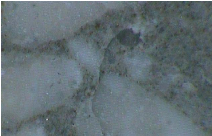
Şekil 7.15. Çatlakın başlamasına neden olan kusur (60x)
