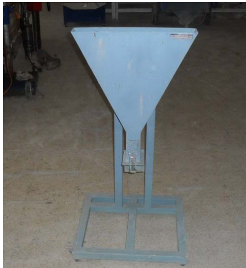
Şekil 6.8. V-hunisi deney aleti
