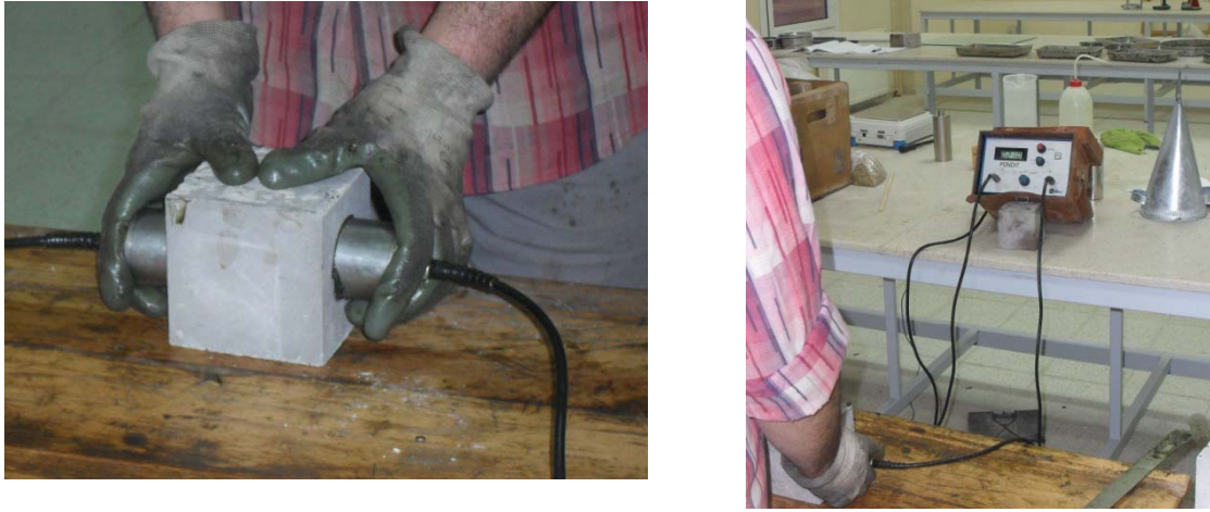
Şekil 6.11. Ultrases geçiş hızı ölçümü
