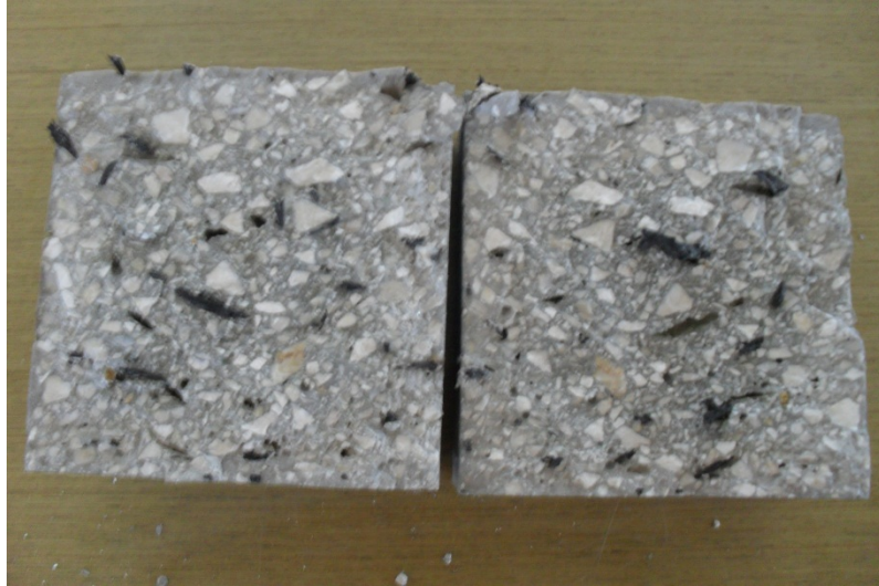
Şekil 7.13. Yarmada çekme dayanımı sonrası genel görünüm (R15 serisi)
