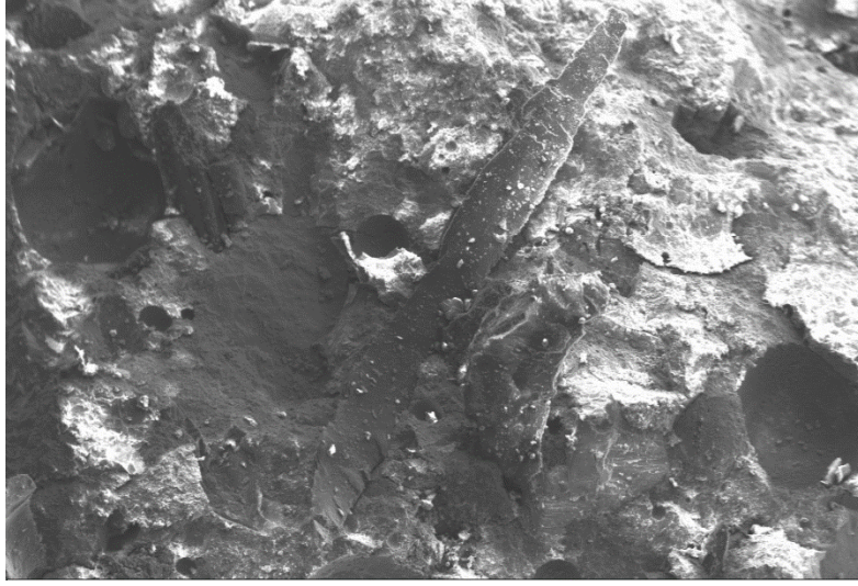
Şekil 7.18. Normal vibrasyonlu lastik agregalı betondan elde edilmiş görüntü (Emiroğlu, 2006).
