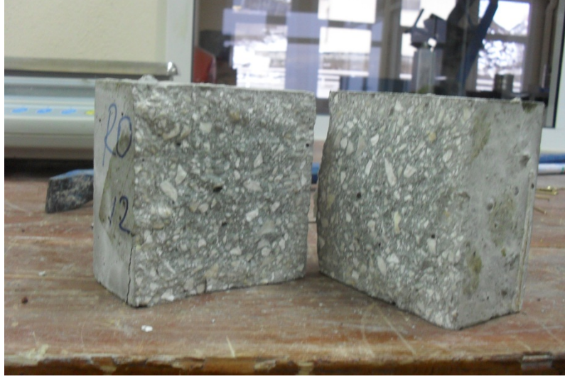
Şekil 7.12. Yarmada çekme dayanımı sonrası genel görünüm (R0 serisi)
