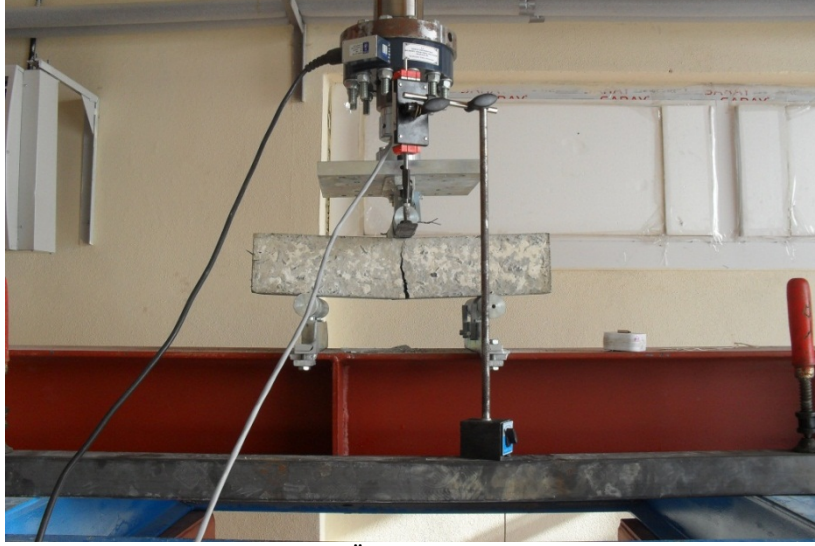
Şekil 6.16. Üç nokta eğilme deneyi
