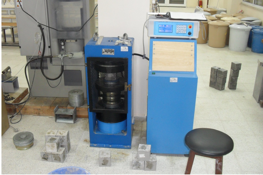
Şekil 6.14. Basınç dayanımı deneylerinde kullanılan hidrolik pres
