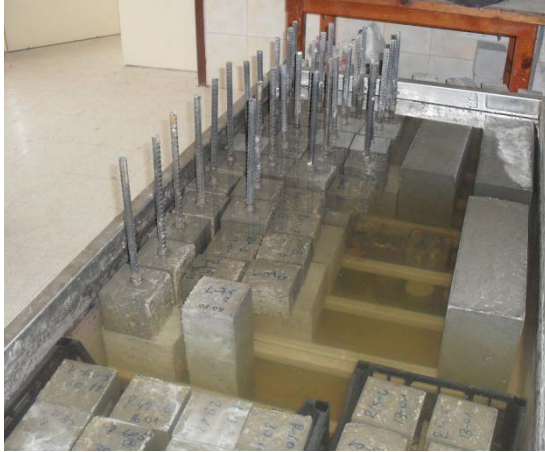
Şekil 6.6. Kür tankında bekletilen numunelerden bir görünüş
