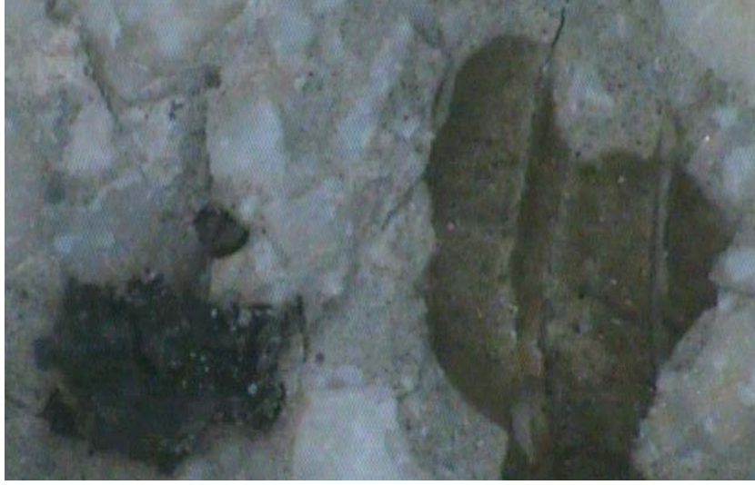
Şekil 7.20. Lastik agregaların betondan sıyırılması (20x)
