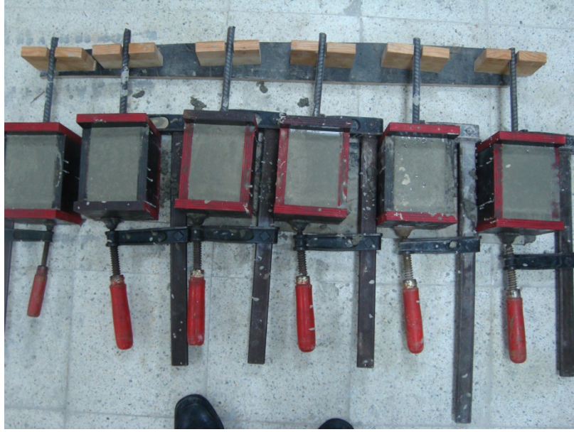
Şekil 6.5. Donatı aderansı deneylerinde kullanılan kalıplar
