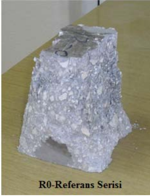
Şekil 7.10. Basınç dayanımı sonrası numunelerde oluşan kırılma yüzeyleri
