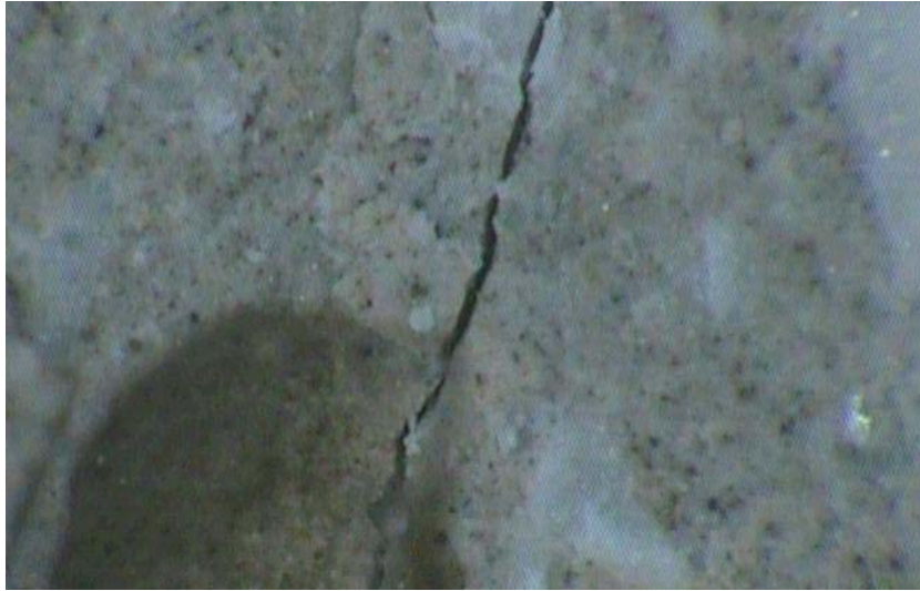
Şekil 7.21. Lastik-harç arayüzeyinde başlayan çatlağın harç üzerinde ilerlemesi (60x)
