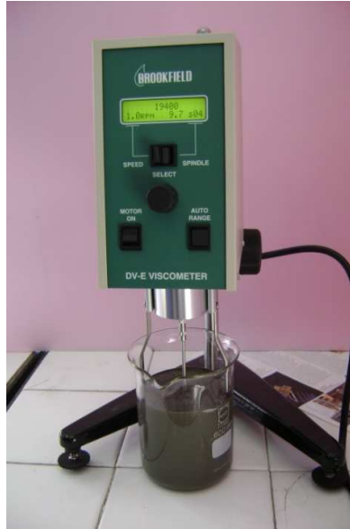
Şekil 5.6 Brookfield DV-E model viskozimetre
