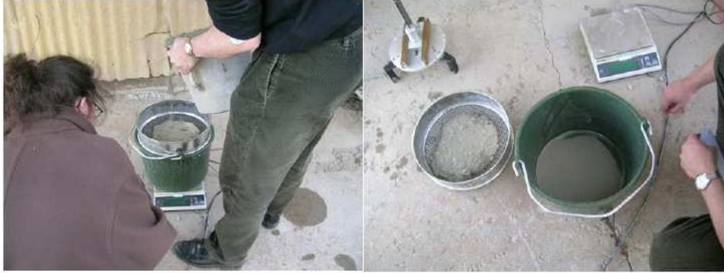
Şekil 3.7 Elek Ayırma Deneyi
