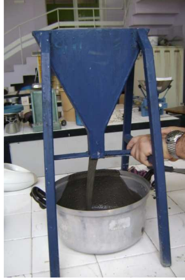
Şekil 5.5 KYH İçin Mini V-Hunisi Deneyi
