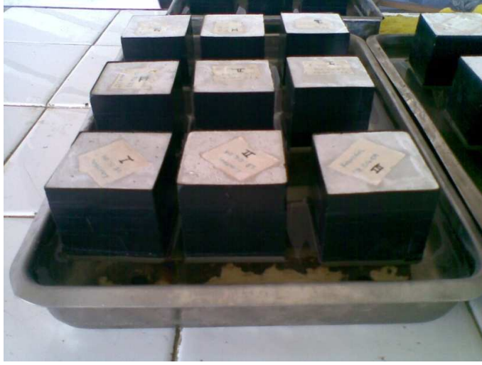
Şekil 5.9 Kapiler Su Emme Deneyi
