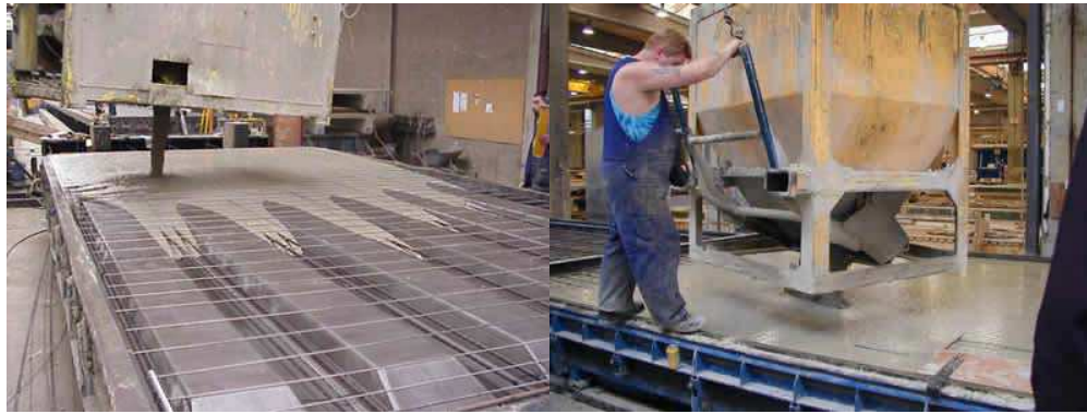
Şekil 1. 6 Prefabrike Beton Üretiminde KYB Uygulanması
