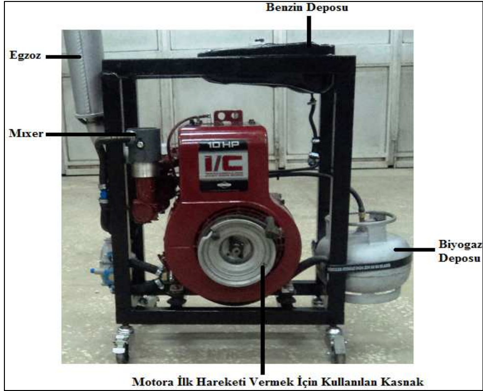
Şekil 4.17. Elde edilen biyogazın yakıldığı deney motoru
