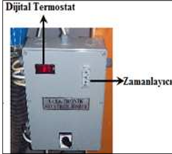
Şekil 4.9. Elektrik motorunu tetikleyen zamanlayıcı
