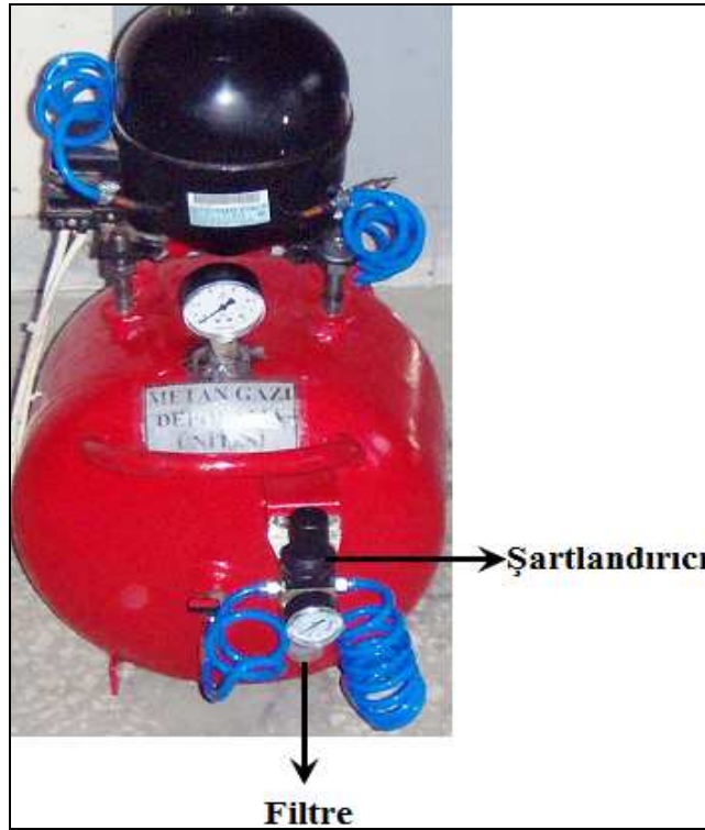
Şekil 4.14. Biyogaz çıkış vanasına bağlanan filtre ve şartlandırıcı
