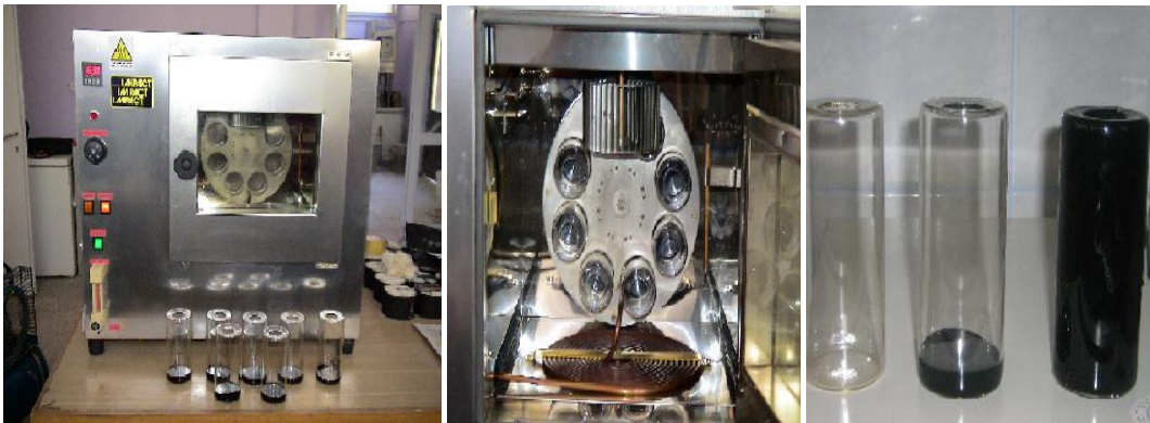
Şekil 4.3. Dönel ince film halinde ısıtma deneyi
