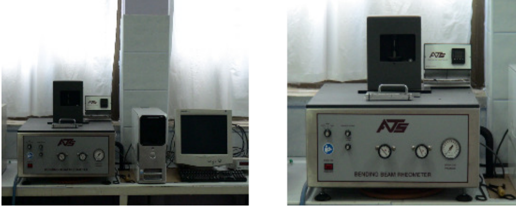
Şekil 4.11. Kiriş eğme reometresi (BBR) deney aleti
