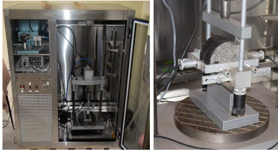
Şekil 6.4. ITSM deney düzeneği
