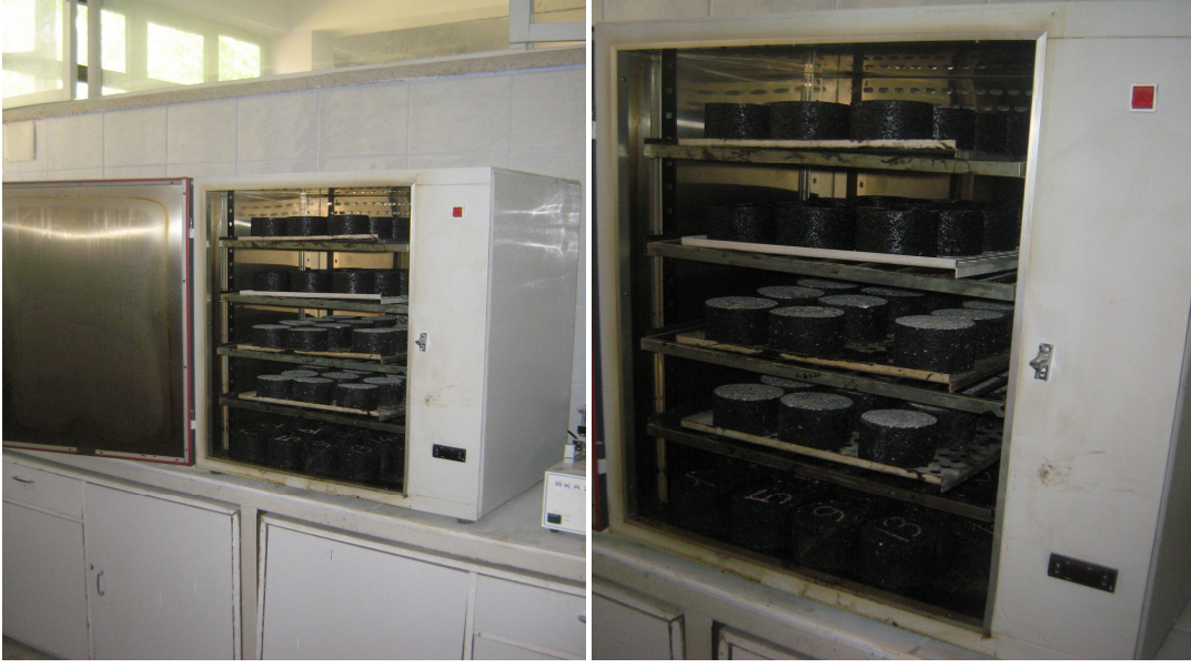
Şekil 5.2. BSK numunelerinin uzun dönem yaşlandırılması
