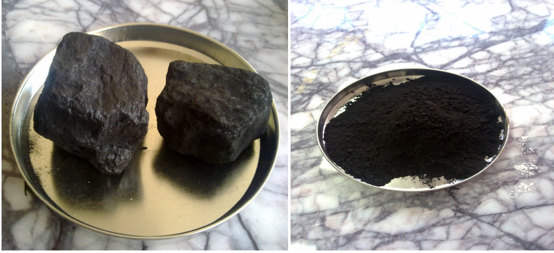
Şekil 7.1. Silopi asfaltinin konkasörde kırılmadan önce ve sonraki hali
