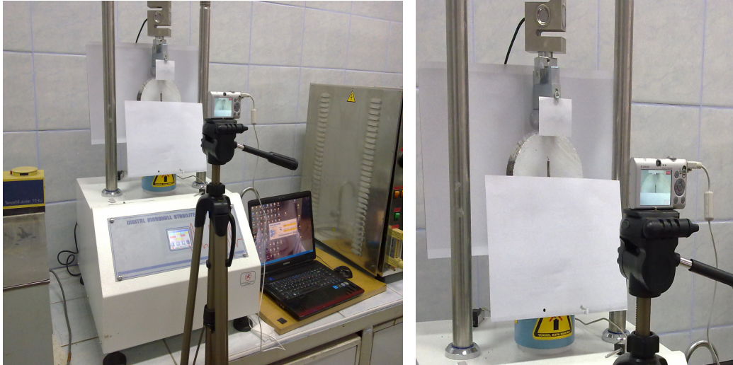
Şekil 6.19. Görüntü işleme için verilerin elde edilmesi
