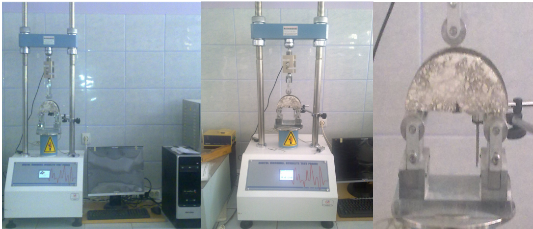
Şekil 7.93. Yarım daire eğilme deney düzeneği
