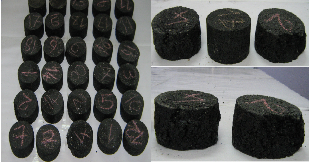
Şekil 7.71. Dinamik sünme deneyi sonrasında numunelerin görünüşü
