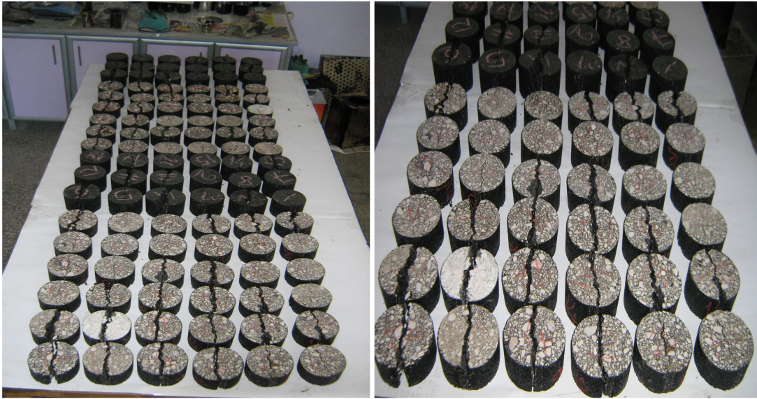
Şekil 7.40. Yorulma deneyi sonrasında numunelerin görünüşü
