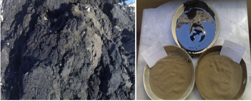
Şekil 3.3. Suriye El-Beşiri katranlı kumunun doğal hali ve ayrıştırılmış hali
