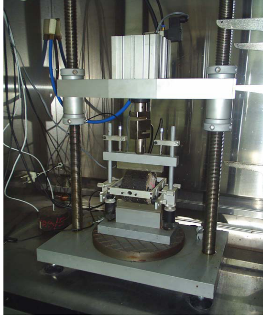
Şekil 6.5. Yorulma deney düzeneği
