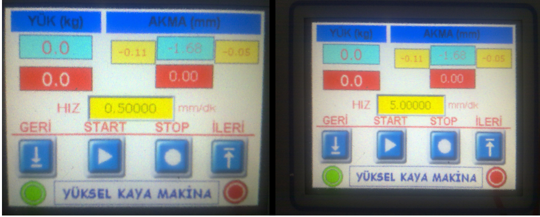
Şekil 7.94. Hızı ayarlanabilir Marshall cihazının dijital göstergesi
