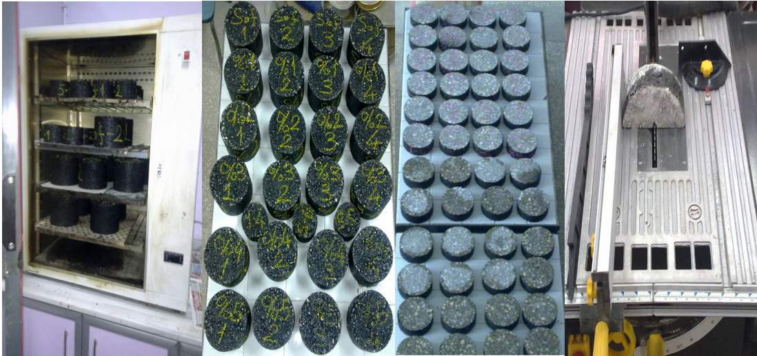
Şekil 7.91. Numunelerin uzun dönem yaşlandırılması ve kesilmesi
