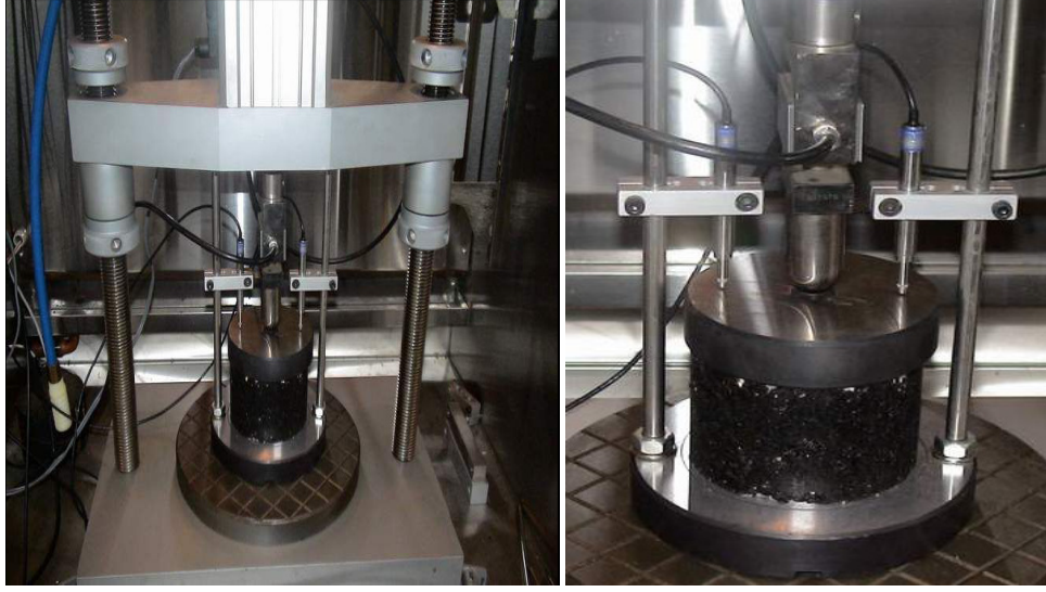
Şekil 6.8. Tekrarlı sünme deney düzeneği
