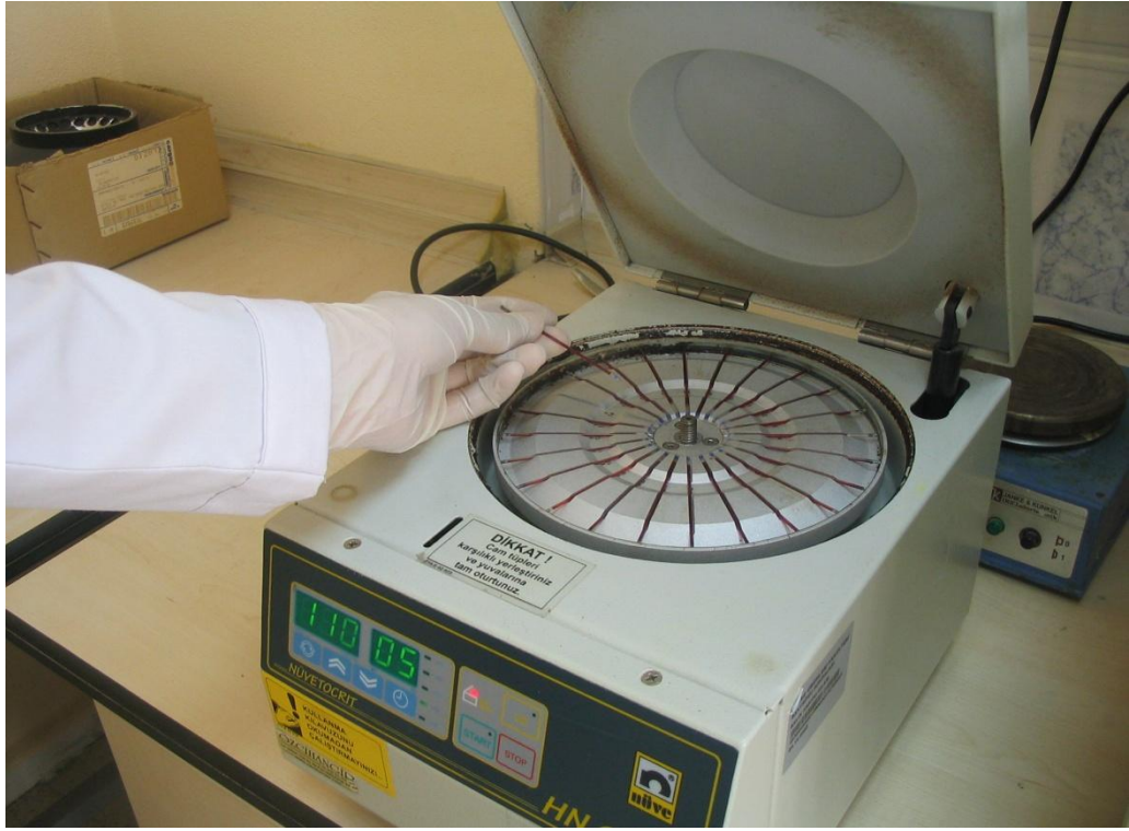
Şekil 2.2.6.1.1. Hematokrit tüplerinin santrifüje yerleştirilmesi (Orijinal)
