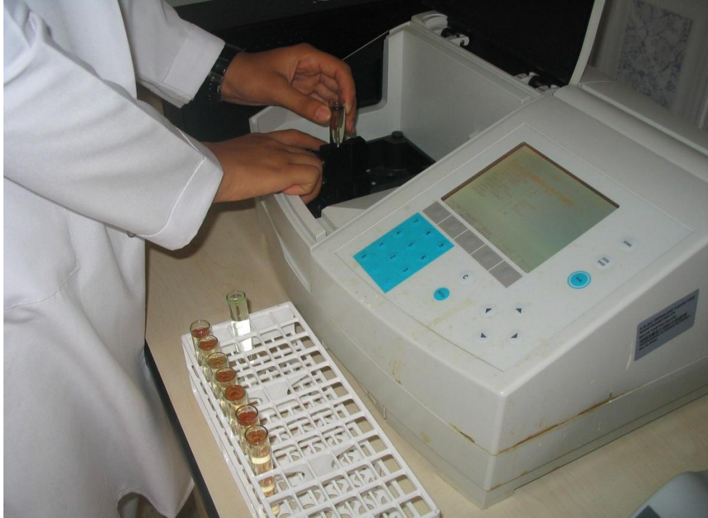
Şekil 2.2.6.3.1. Spektrofotometrede hemoglobin miktarının belirlenmesi (Orijinal)
