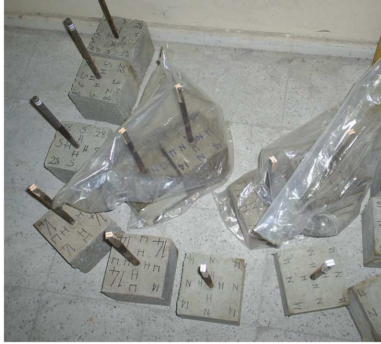
Şekil 4.4 Hava kür koşulu uygulanan numuneler
