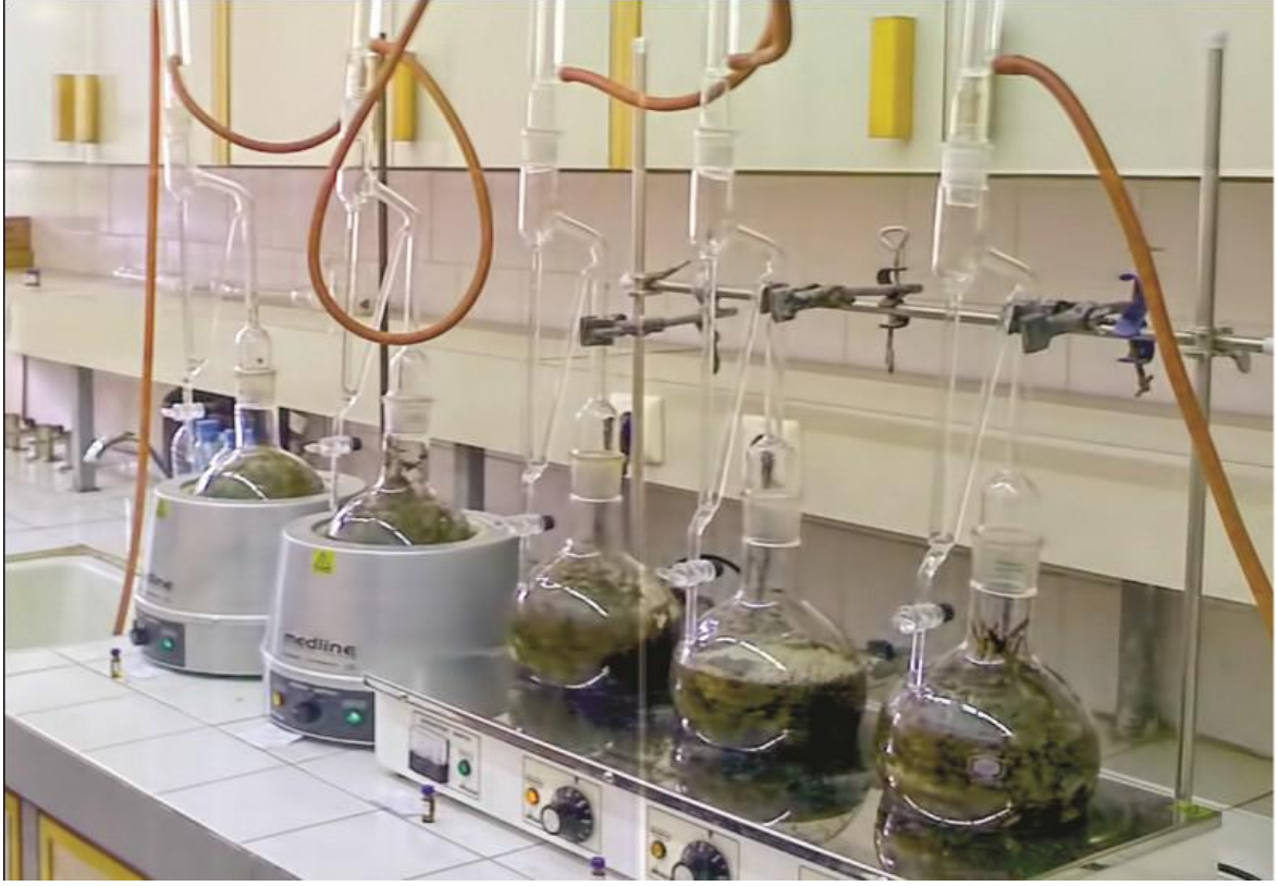
Şekil 2.1. Su destilasyon apareyi ve yağ elde edilişi
