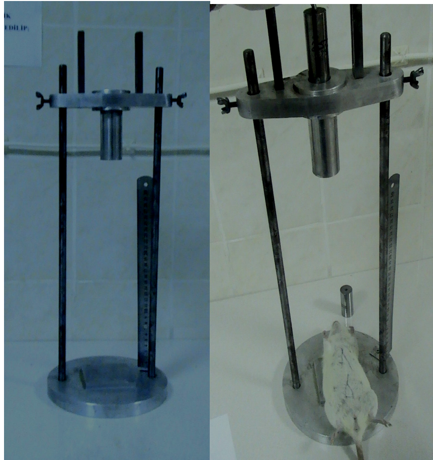
Şekil 5: Travma uygulamak için kurulan düzenek.
