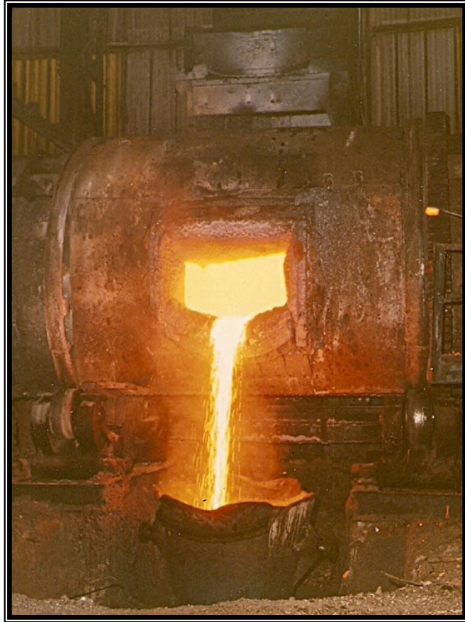
Resim 33 – Blister bakır fırından akarken ( www.madenliyiz.biz sitesinden alınmıştır)
