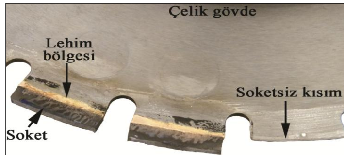
Şekil 2.13. Sert lehim yapılmış soketin detay görünümü.
