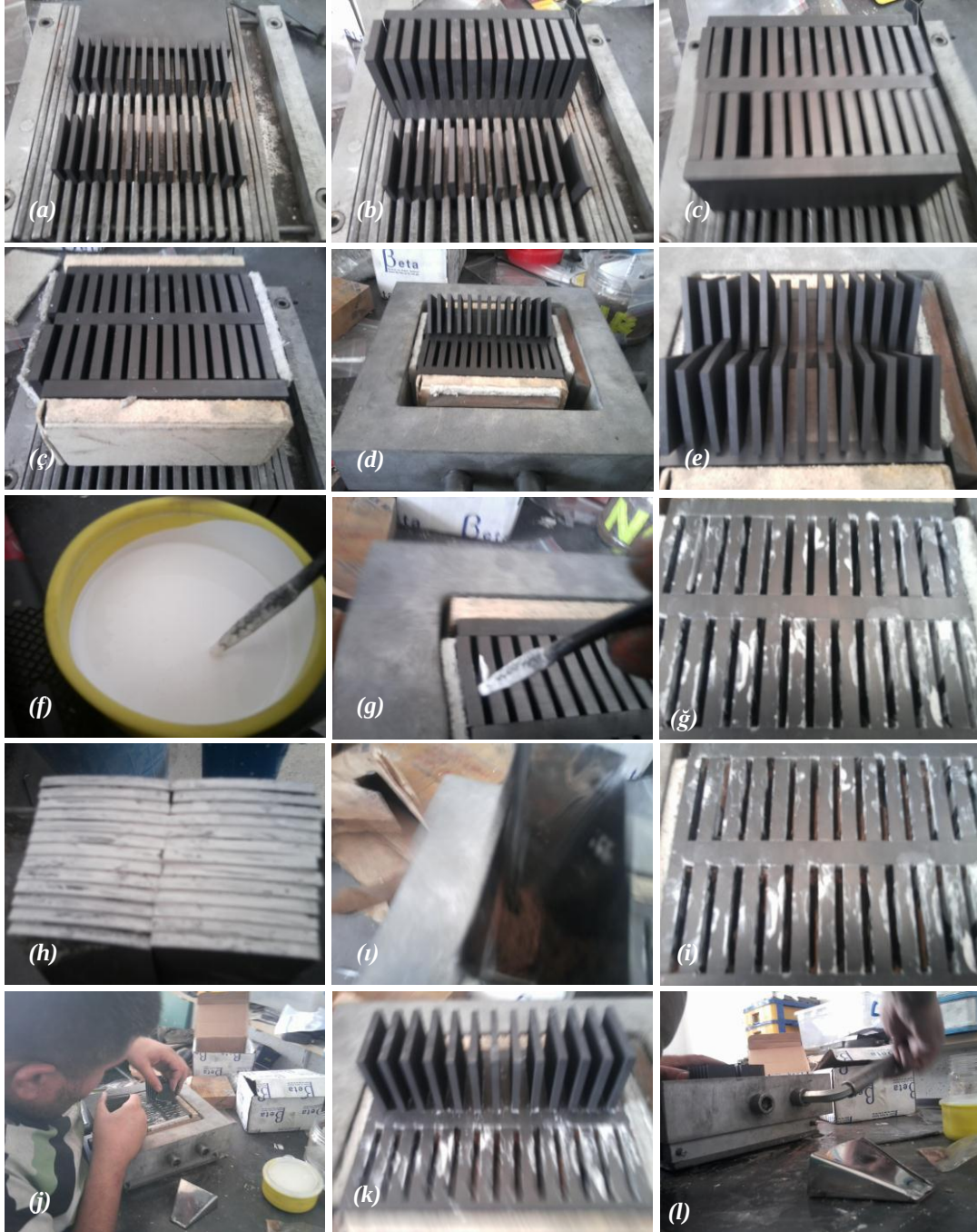
Şekil 2.6. Kalıp hazırlanması ve tozların kalıba yerleştirilmesi.
