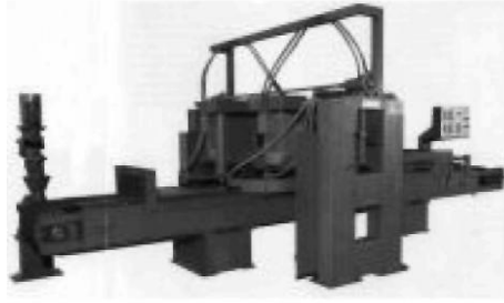
Şekil 1.25. Yatay yarma makinesi
