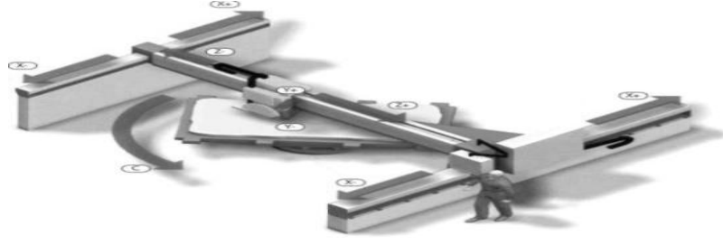
Şekil 1.23. Köprü kesme makinesinin hareketlerini gösteren şematik görünüm
