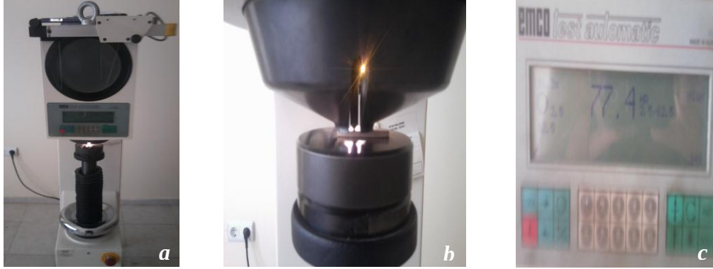
Şekil 2.19. (a) BSD Ölçüm Cihazı (b) ölçüm aparatı, tablası ve ölçüm anı (c) ölçüm ekranı
