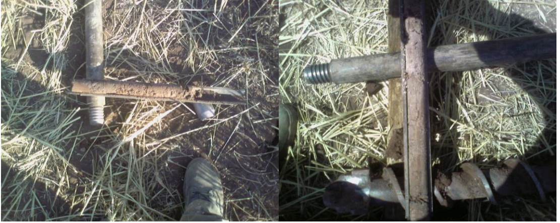
Şekil 3.6. 5 nolu temel sondajının 3. ve 6. metredeki görünümü. Spt deneyi sonucunda zemin; açık kahve renkli katı kildir.
