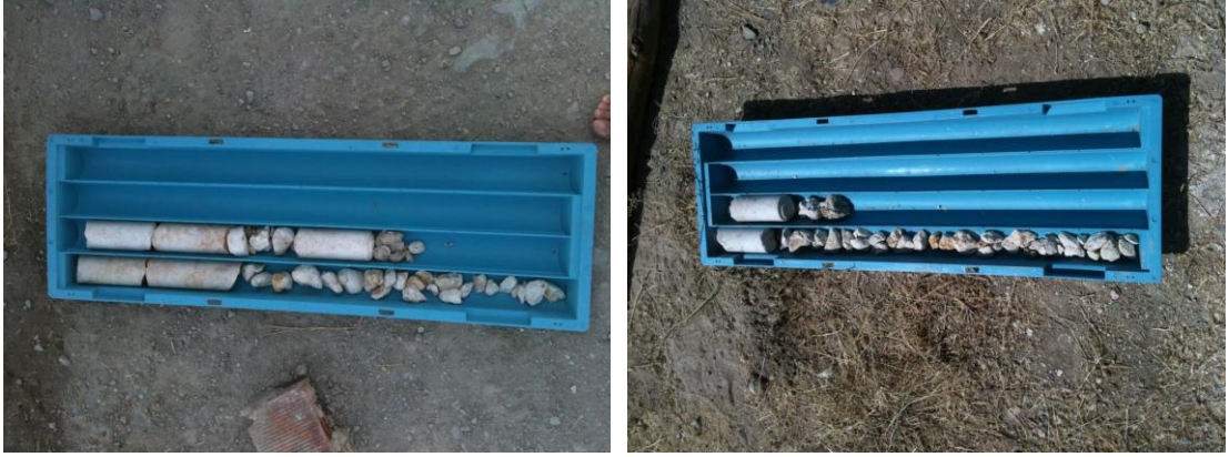
Şekil 4.1. 14 ve 15 nolu kuyularda 1,5 metrelik karot takımından alınan numuneler
