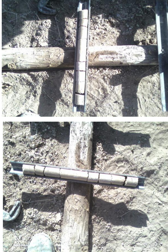
Şekil 3.10. 8 nolu temel sondajının 4,5 metresinde yapılan spt görünümü. Spt sonucuna göre zemin; açık kahve renkli katı kildir.
