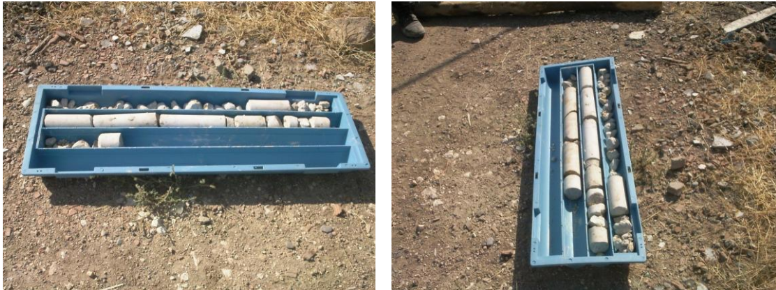
Şekil 4.2. 16 ve 17 nolu kuyularda 3,0 metrelik karot takımından alınan numuneler
